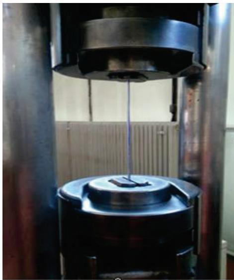
**Slika 6.** Postupak ispitivanja vučene žice zatezanjem [3]
