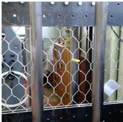
**Slika 7.** Uzorak pletiva za ispitivanje u kidalici [6]
