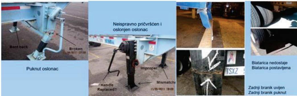
**Slika 5. Oštećenja na priključnim vozilima**
