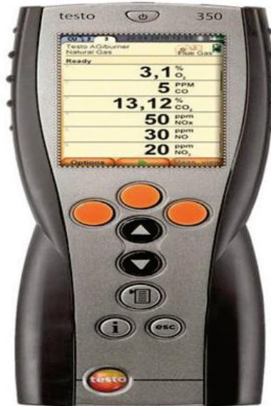
Slika 1. Instrument za mjerjenje emisijskih polutanata (Testo)
