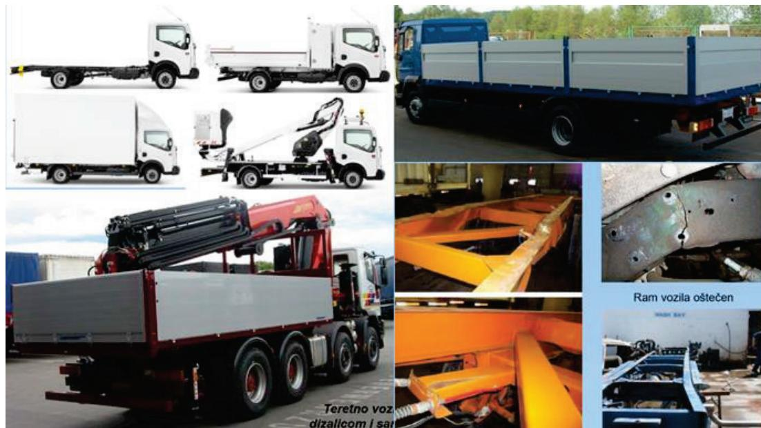
**Slika 2.** Primjeri različitih nadgradnji i mogućih deformacija šasija
