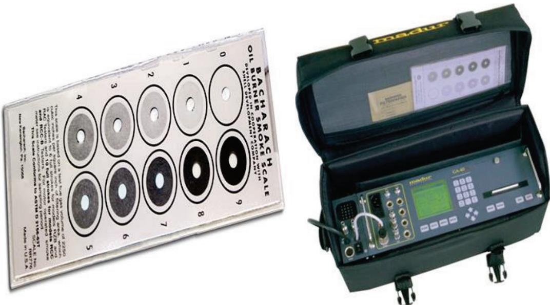
Slika 2. Bacharach dimna skala i elektronski mjerni instrument (MD Madur)
