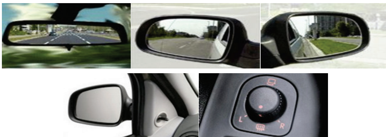
Slika 4. Retrovizori u vozilu i načini podešavanja
