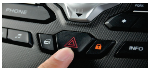
Slika 2. Uređaj za istovremeno uključivanje svih pokazivača smjera
