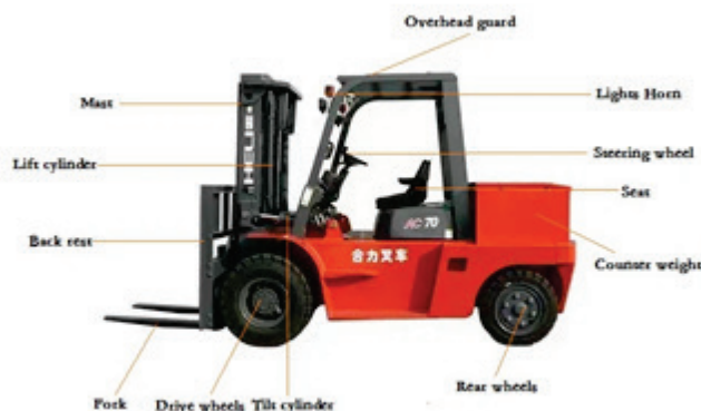
Slika 2. Osnovni dijelovi viljuškara
