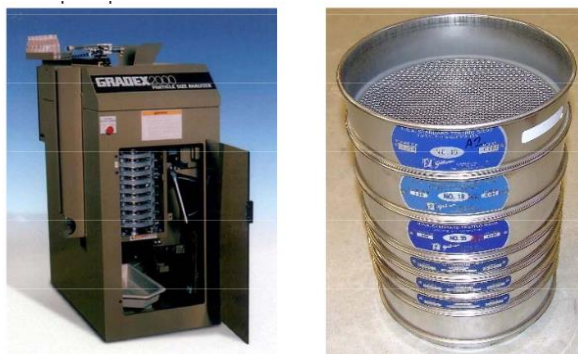
Slika 4.2. Sita za sortiranje čestica [23]
