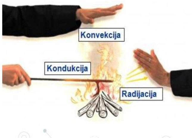
Slika 4.9. Šematski prikaz prenosa toplote: konvekcija, kondukcija i zračenje-radijacija ( https://odseknis.akademijanis.edu.rs › Kondukcija )
