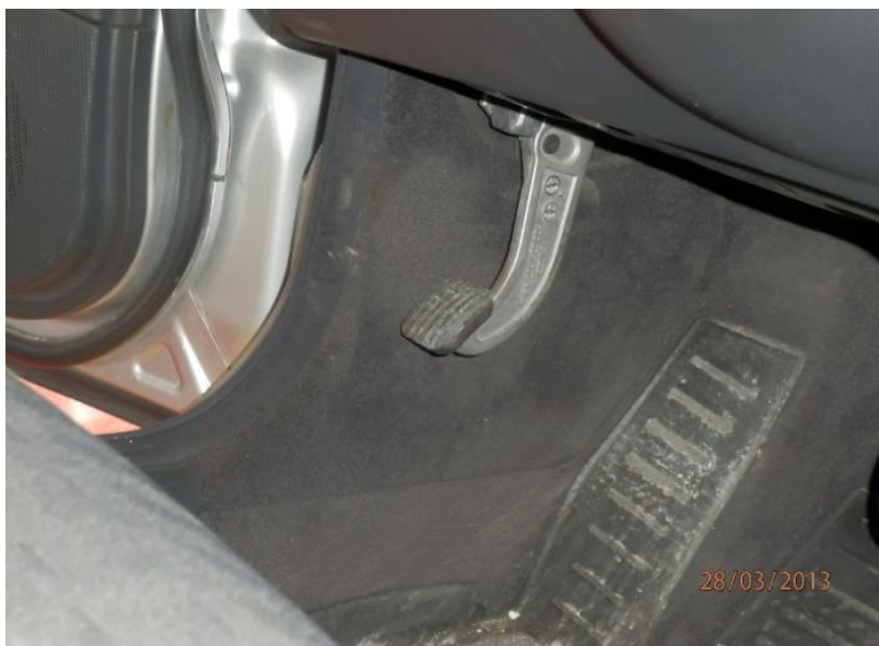
Nožna poluga za aktivaciju pomoćne kočnice
