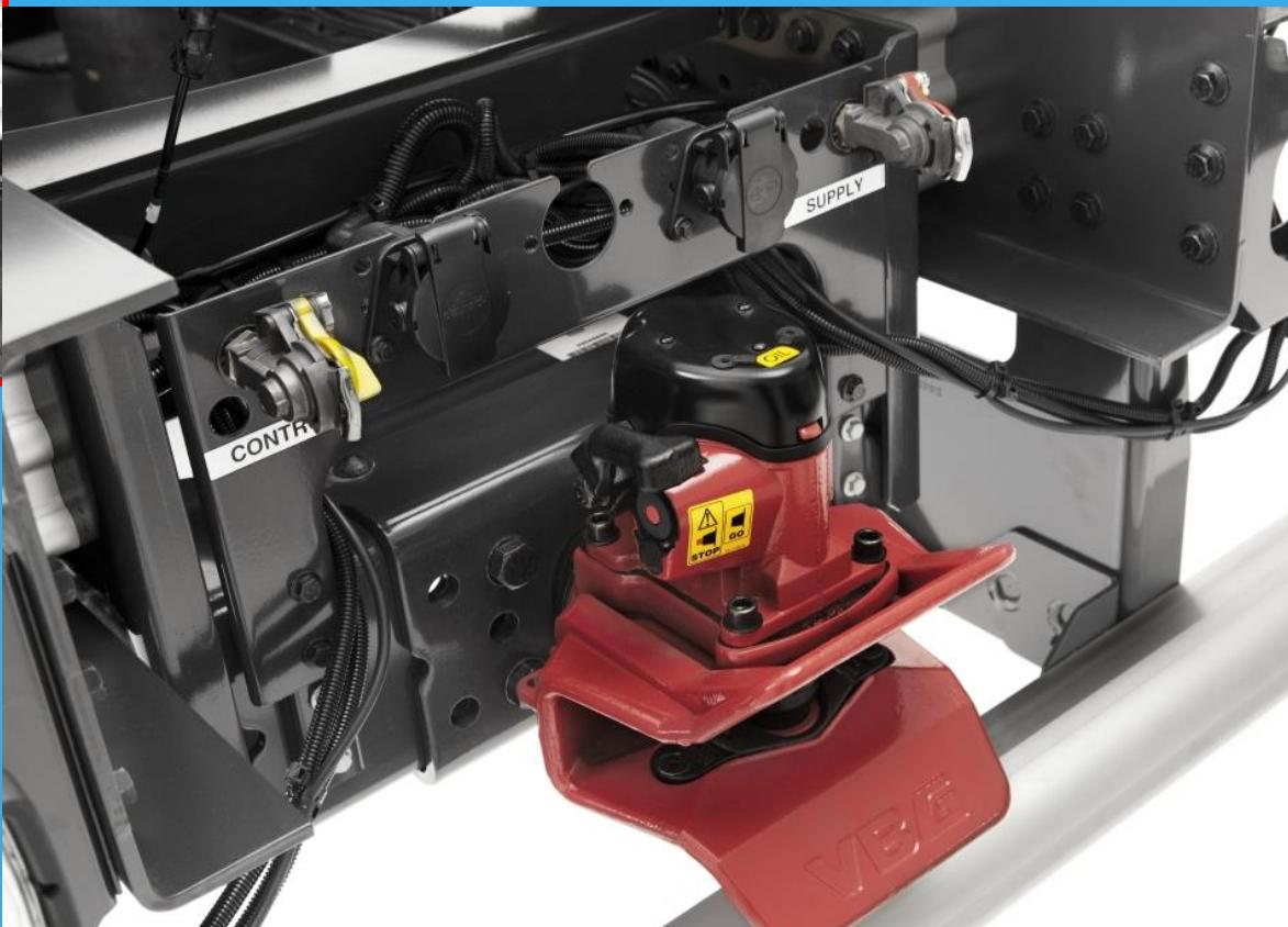
Primjer moguće ugradnje vučne kuke
