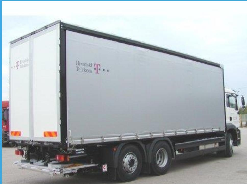
Primjer ugradnje utovarne platforme na veze osnovnog i dodatnog rama
