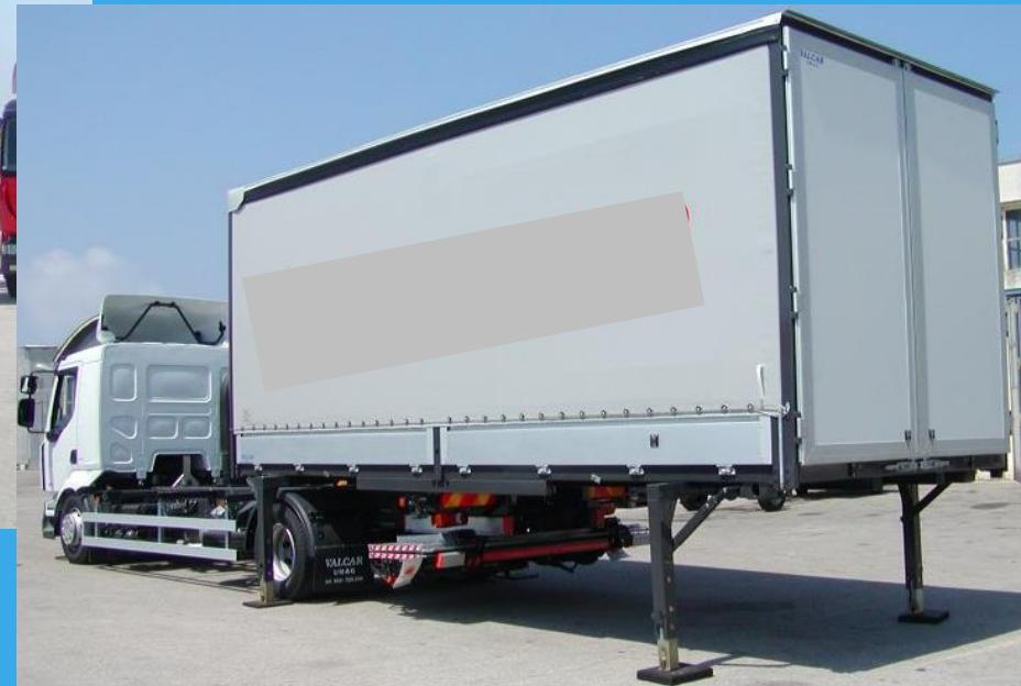
Primjer ugradnje promjenljive nadgradnje na veze osnovnog i dodatnog rama
