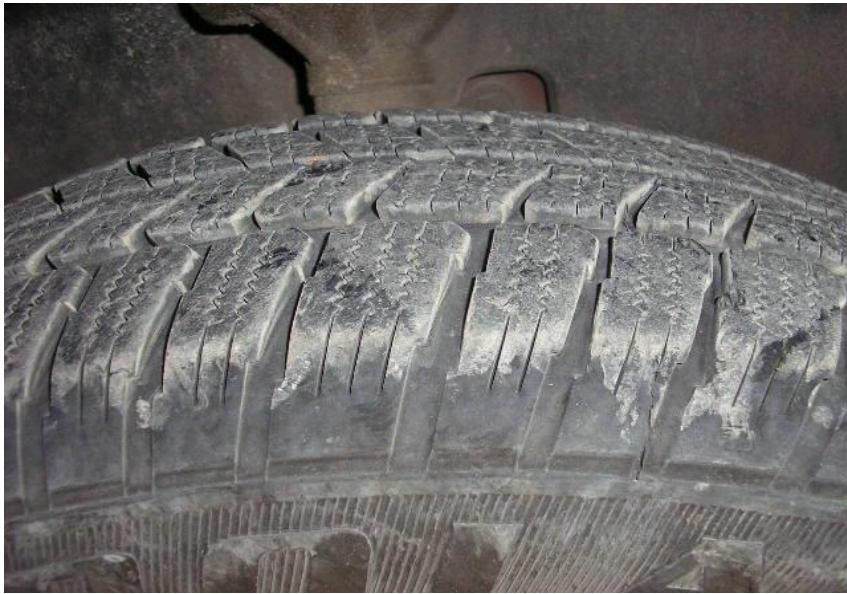
Zakrenite upravljačke kotače, kontrolirajte bočni dio gume i potražite TWI oznaku
