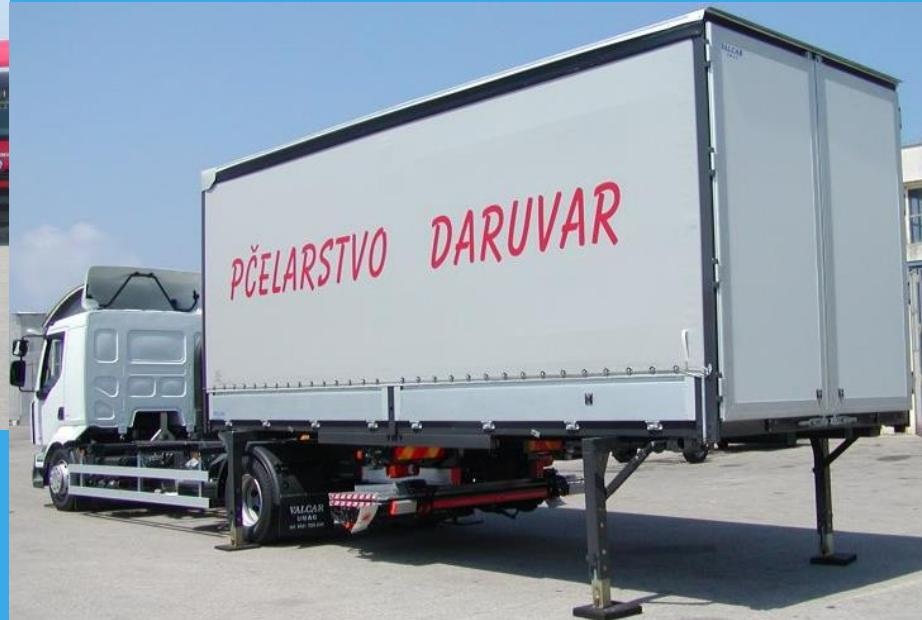
Slika. Primjer ugradnje promjenljive nadgradnje na veze osnovnog i dodatnog rama
