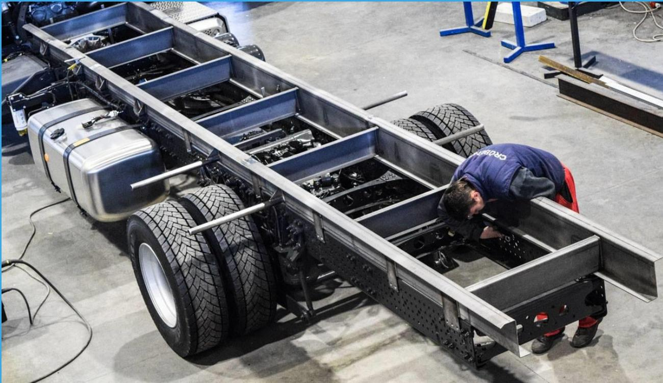
Slika. Primjer ugradnje veza osnovnog i dodatnog rama
