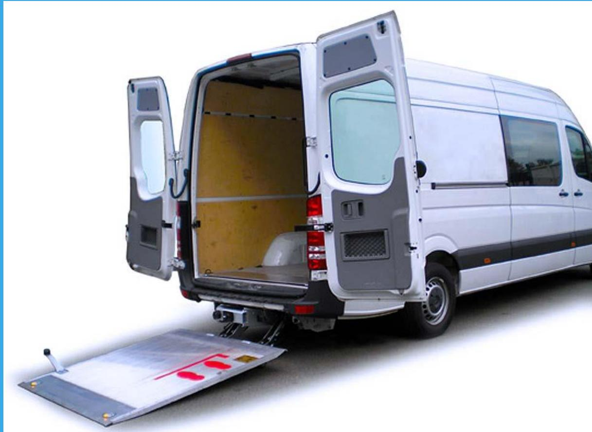
Slika. Primjer ugradnje utovarne platforme na vozilu do 5 t
