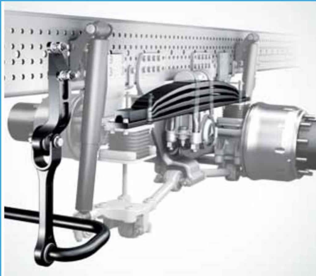
Slika. Stabilizator za ojačavanje zadnjih osovina teretnih vozila.
