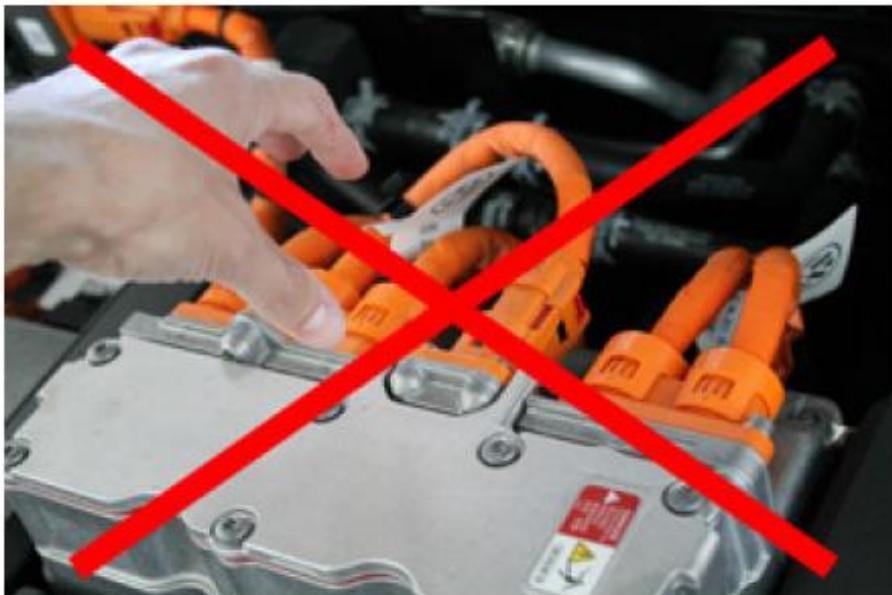
Stanje visokonaponskih kablova provjerava se isključivo vizuelno. Visokonaponske kablove je strogo zabranjeno dodirivati i provjeravati njihovo pričvršćenje i stanje priključaka jer postoji opasnost od strujnog udara.
