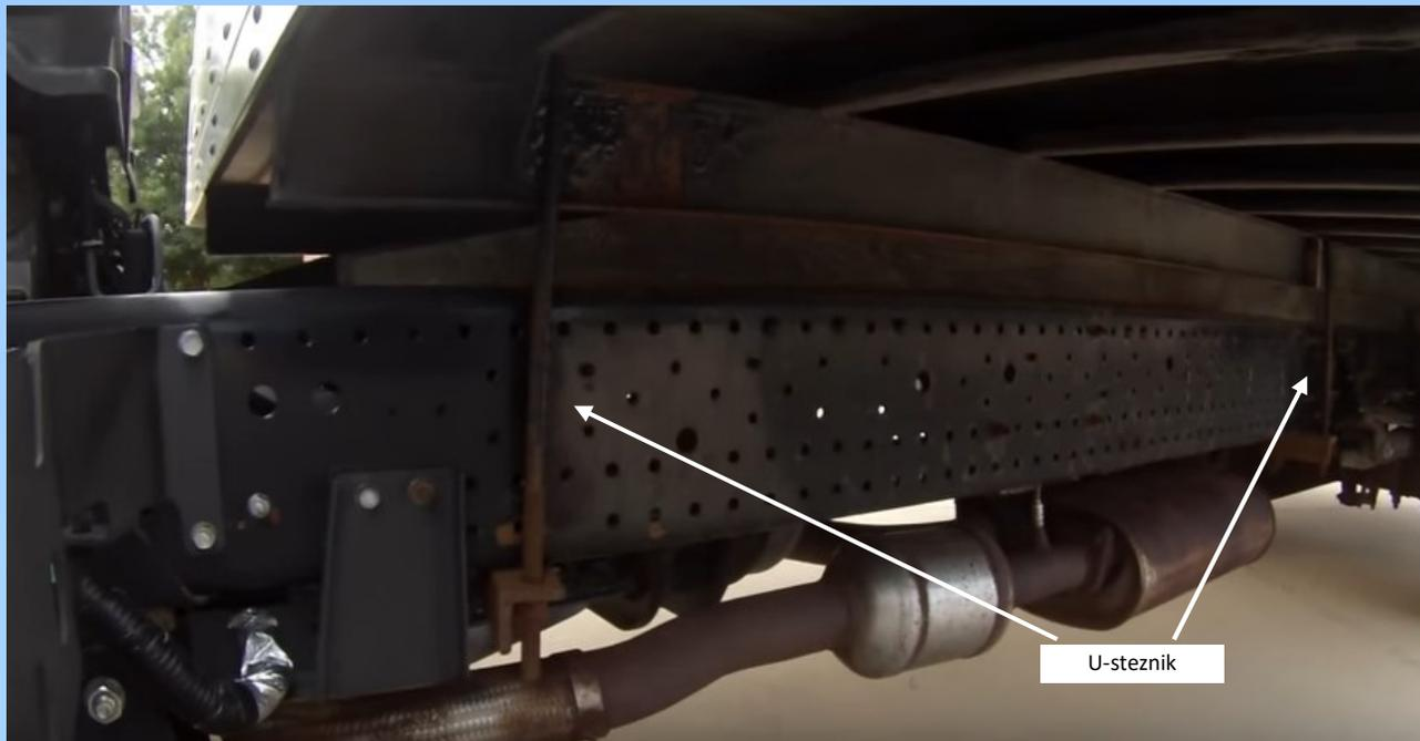
Slika . Prikaz U-steznika na vozilu.
