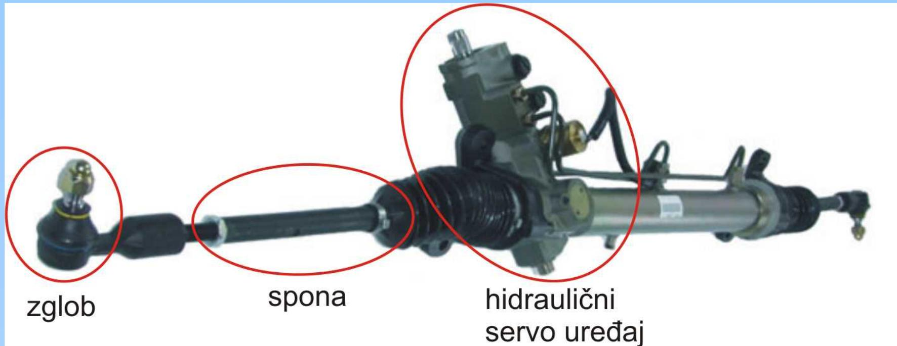
***Prijenosni mehanizam hidromehaničkog upravljanja***
