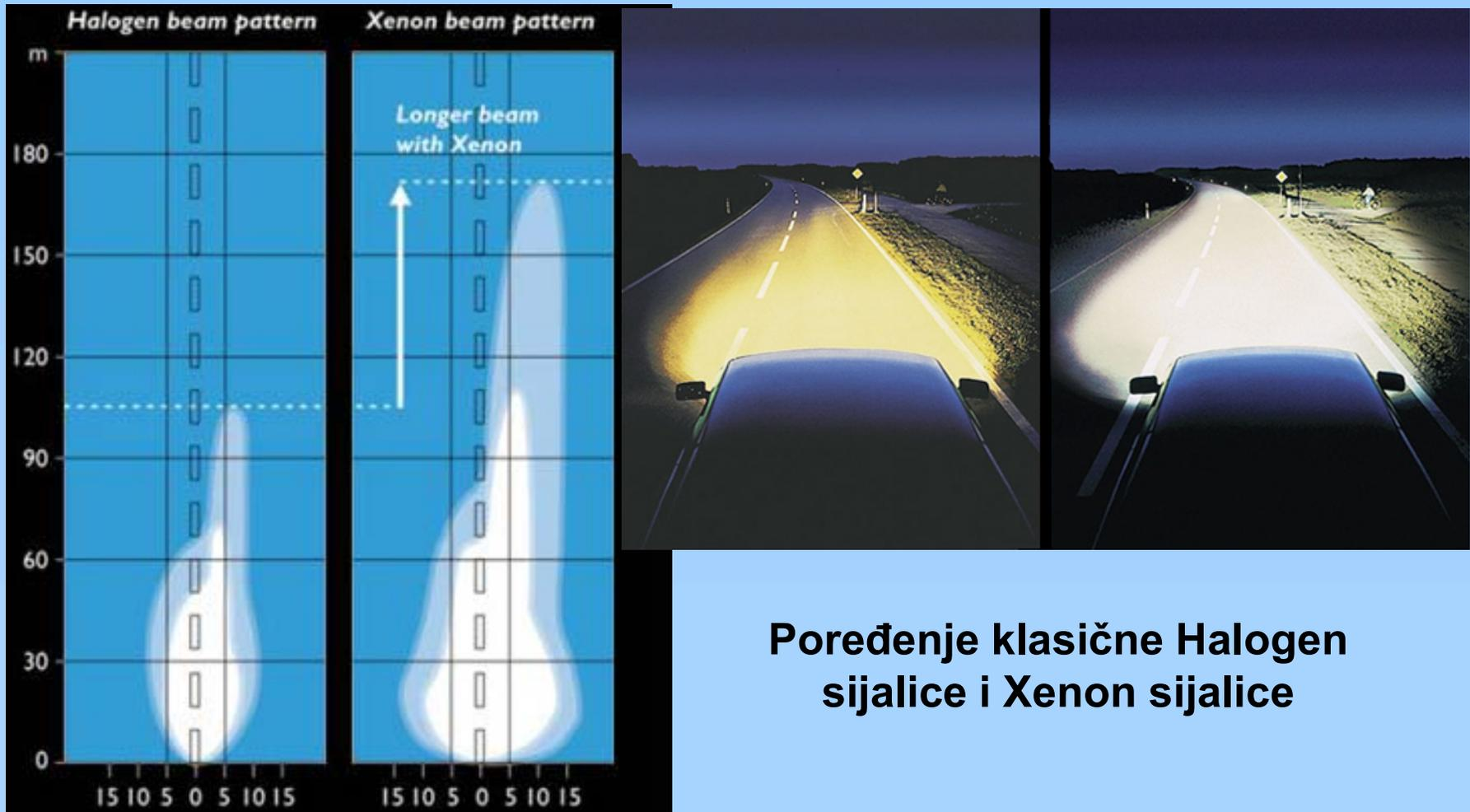
**Poređenje klasične Halogen sijalice i Xenon sijalice**
