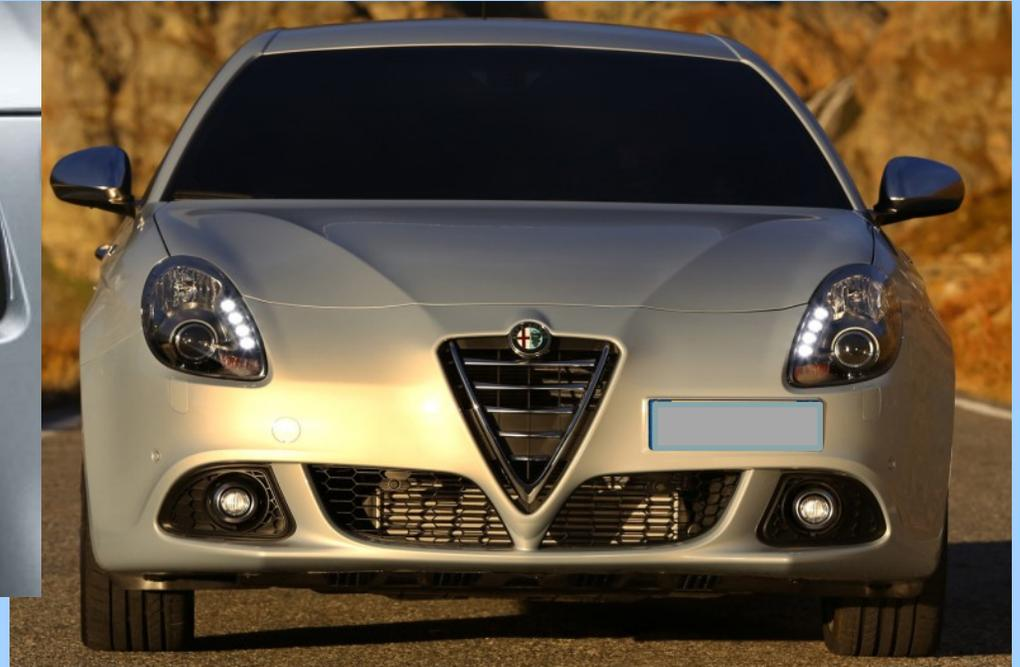
**Uređaji za osvjetljenje i svjetlosnu signalizaciju – ksenon i dnevna svjetla**
