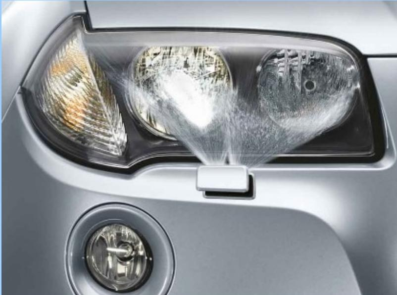
**Uređaji za osvjetljenje i svjetlosnu signalizaciju - prskalice**
