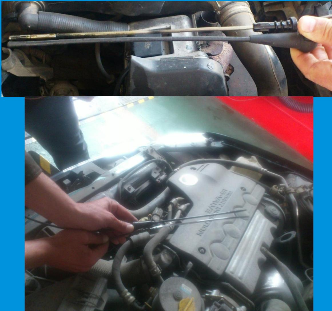
Podešavanja dužine sonde za mjerjenje temperature ulja u motoru
