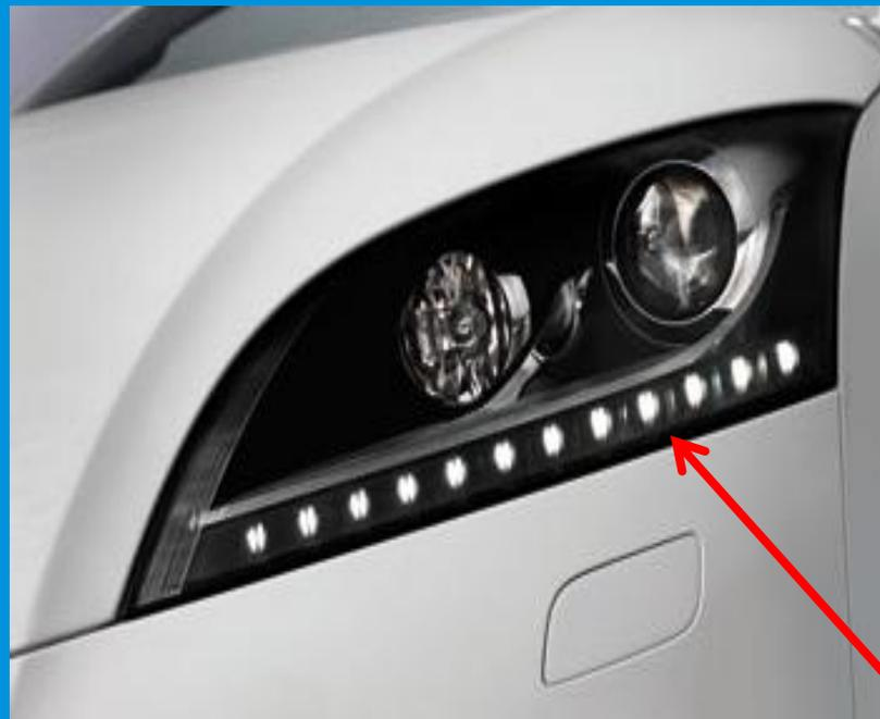
*LED sistem prednjeg osvjetljenja vozila (lijevo) i dnevna LED svjetla (desno)*
