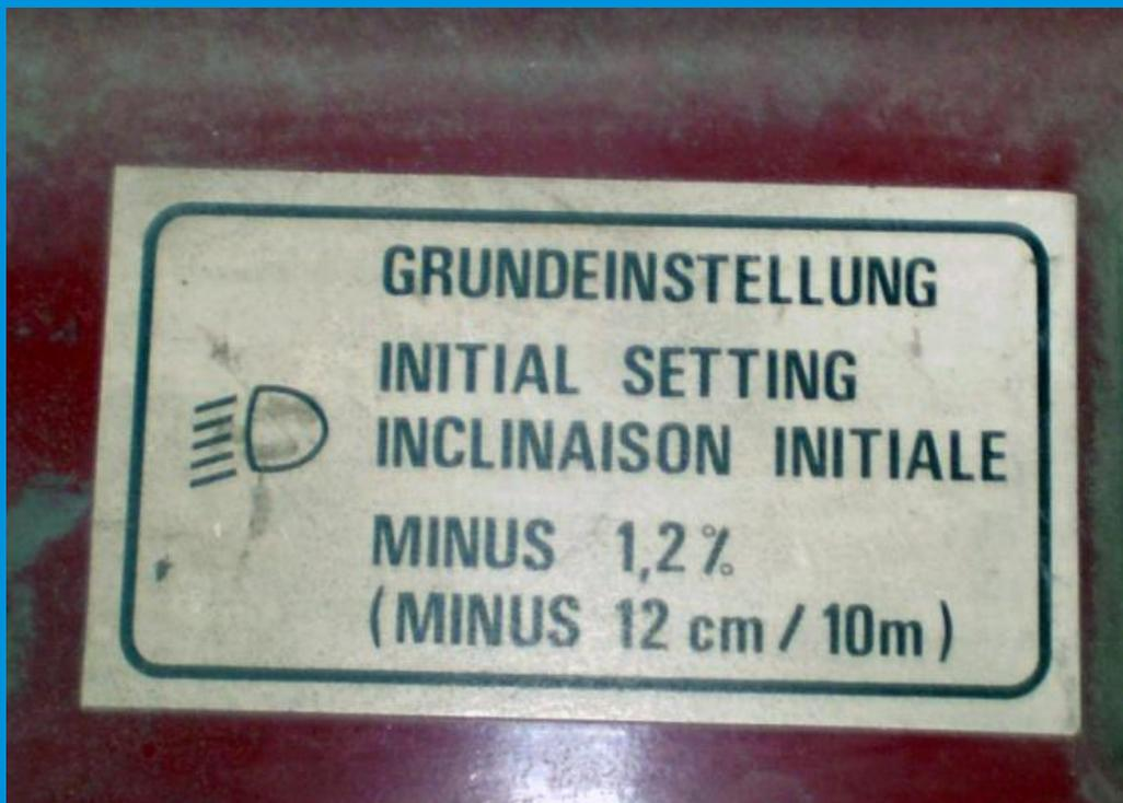
Slika. Znak pada snopa svjetlosti za kratka svjetla – vozilo marke FORD, model ESCORT
