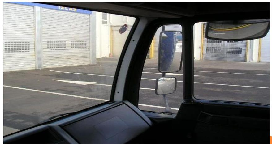
Slika 14. Primjeri dobre ugradnje zrcala na teretnim vozilima
