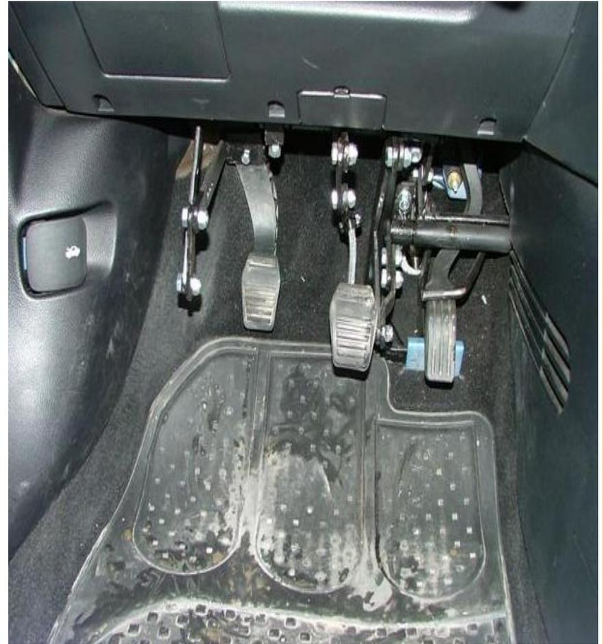
Slika 4. Primjeri **loše izvedene** konstrukcije i ugradnje u osobna vozila, vozilo ne zadovoljava na tehničkom pregledu
