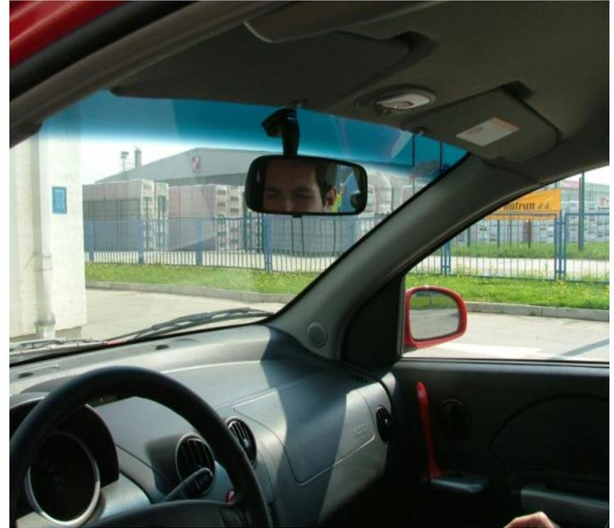
**Slika 13. Primjeri loše ugradnje zrcala na osobnim vozilima (vidna polja), vozilo ne zadovoljava na tehničkom pregledu**
