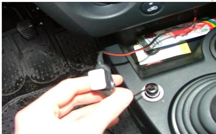
Slika 10. Primjeri **loše ugradnje** uređaja za davanje zvučnih signala, vozilo ne zadovoljava na tehničkom pregledu
