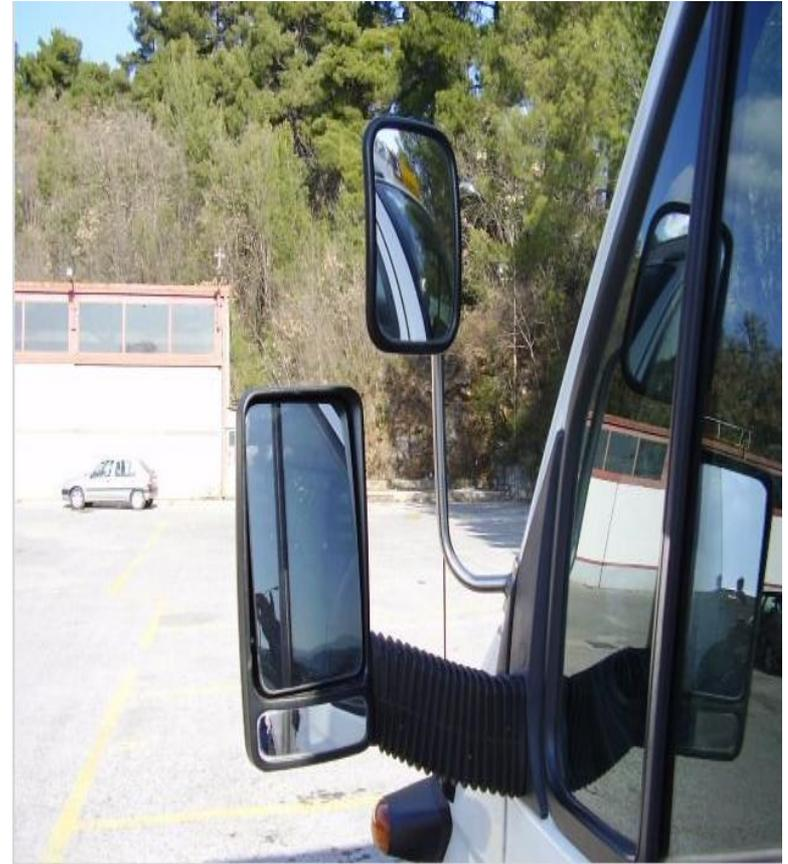
Slika 15. Primjeri **loše ugradnje** zrcala na teretnim vozilima, vozilo ne zadovoljava na tehničkom pregledu
