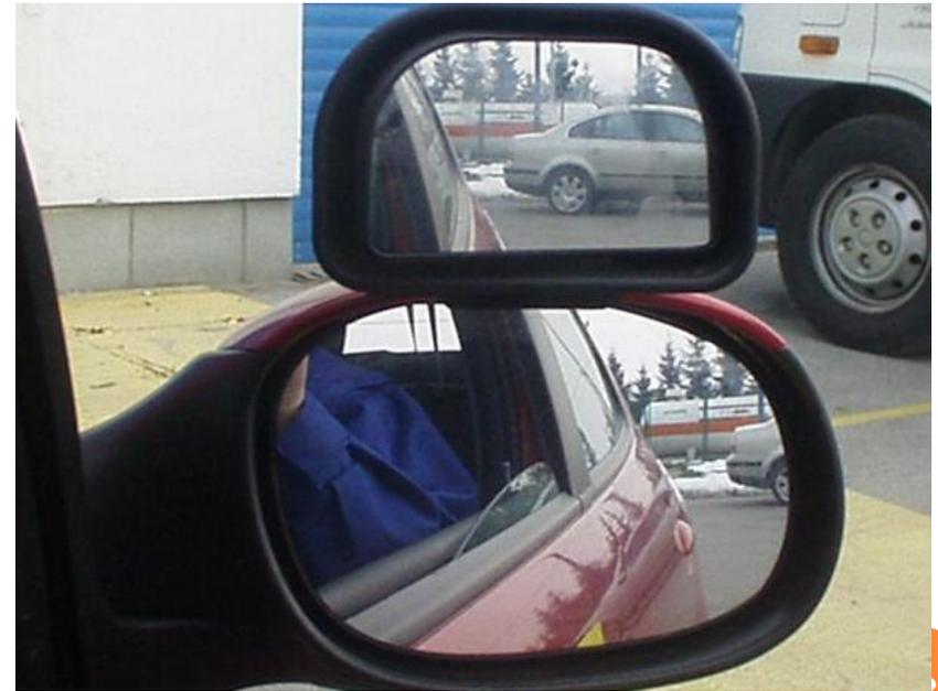
Slika 12. Primjeri dobre ugradnje zrcala na osobnim vozilima (vidna polja)
