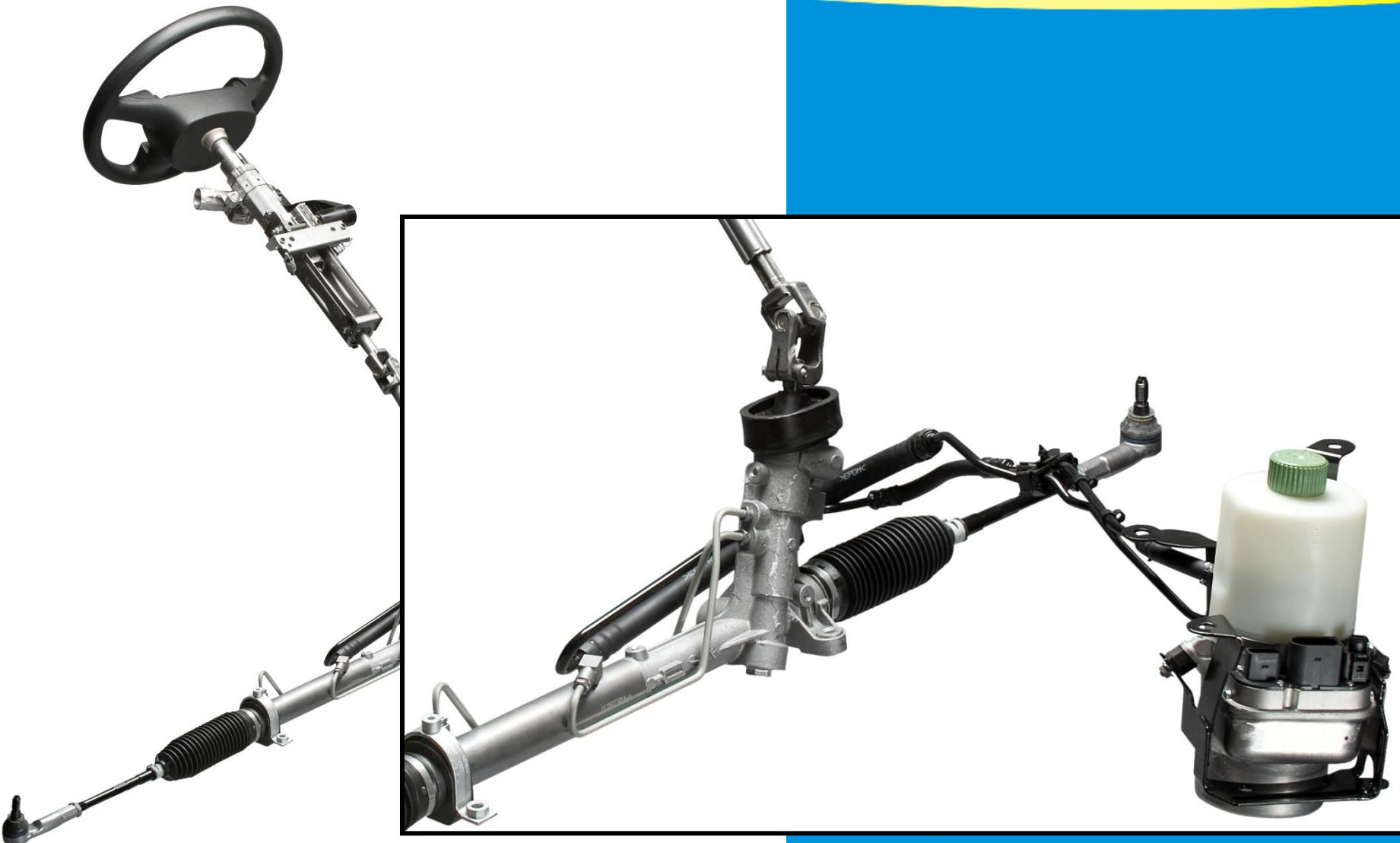
*Prijenosni mehanizam hidromehaničkog upravljanja*
