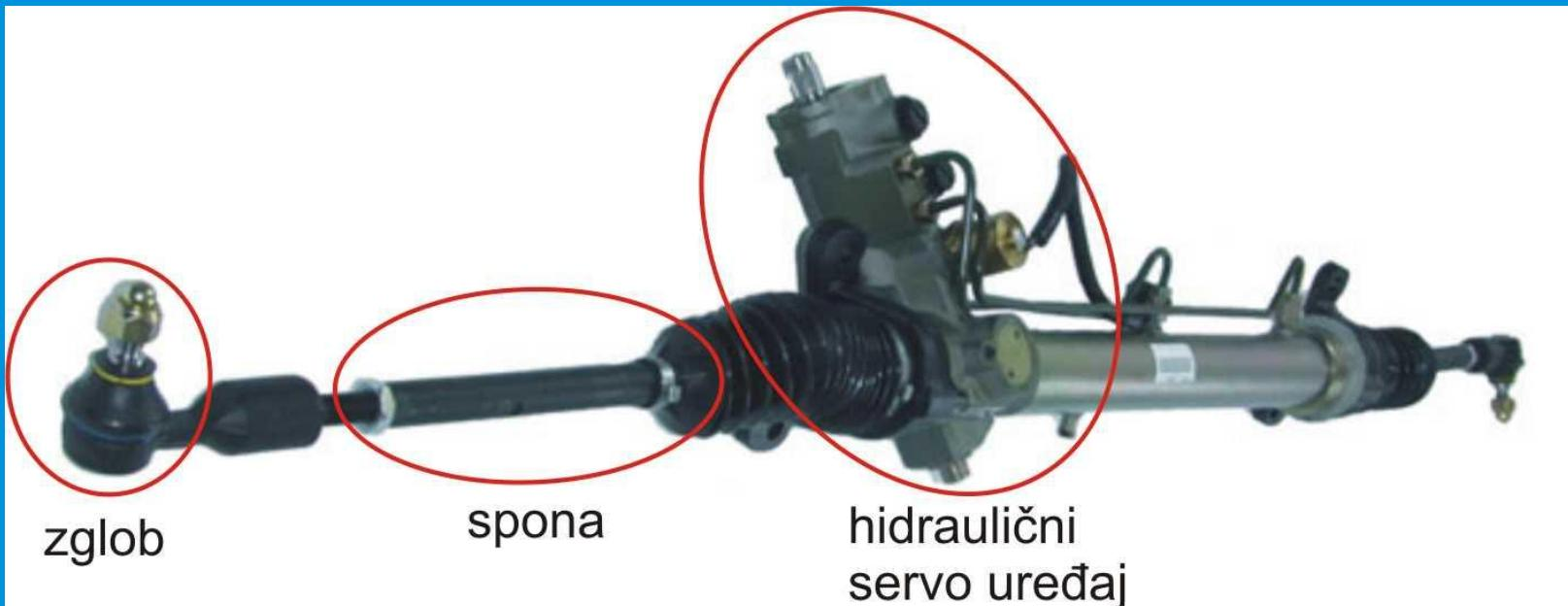
*Prijenosni mehanizam hidromehaničkog upravljanja*
