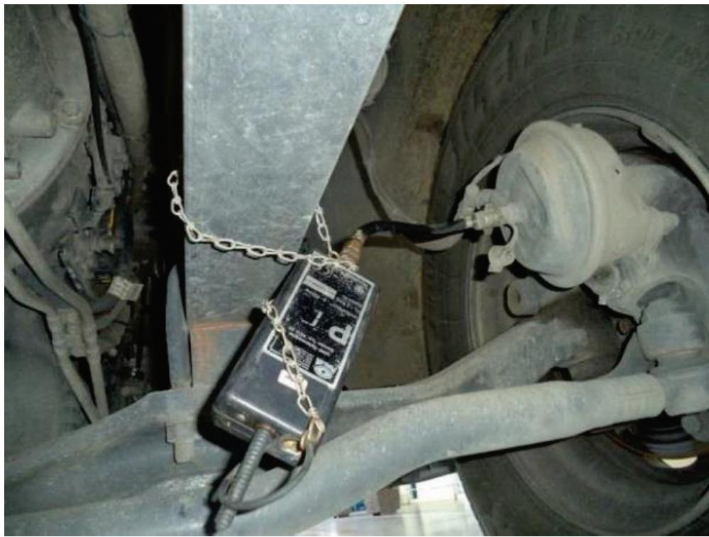
**Slika 9.** Postavka senzora px1 na ispitivanom vozilu (starija vozila ili prikručna)
