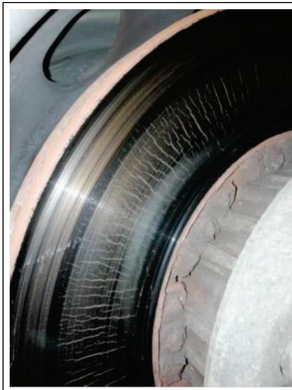
**Slika 19.** Prikaz izgleda ispucalog diska kod starijih vozila (lijeko).
