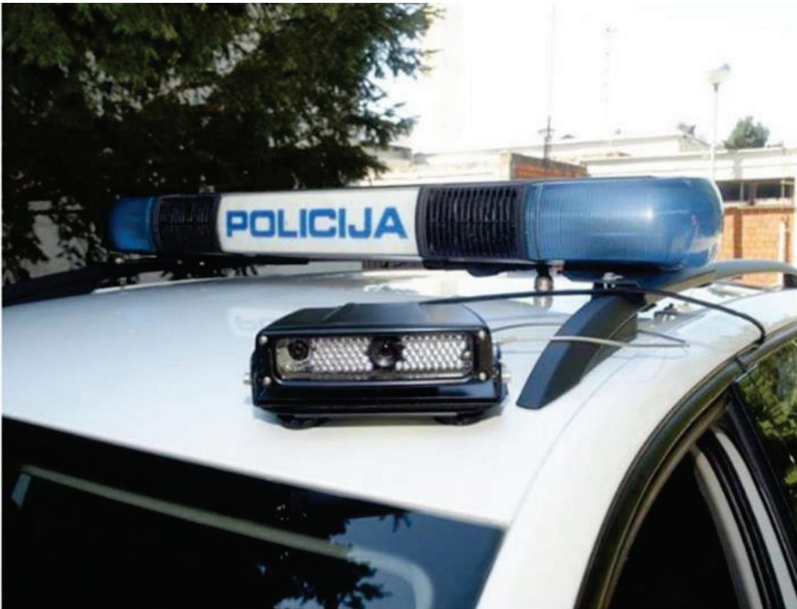
*Slika 2. 3D kamera namontirana na patrolno policijsko vozilo. [7]*
