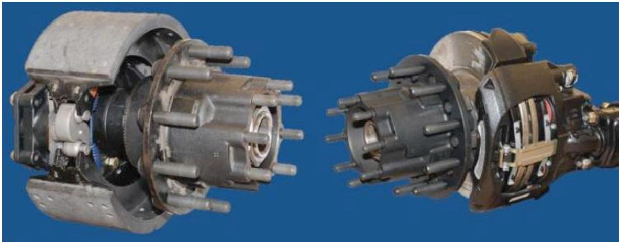
**Slika 2.** Prikaz zračnih kočnica: bubanj kočnice (lijevo), disk kočnice (desno)
