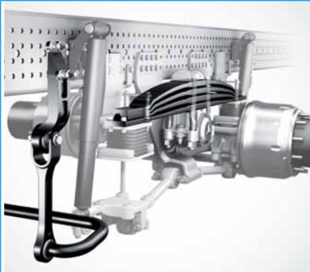
Slika 52. Stabilizator za ojačavanje zadnjih osovina teretnih vozila.
