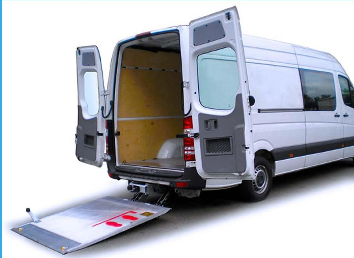
Slika 28. Primjer ugradnje utovarne platforme na vozilu do 5 t
