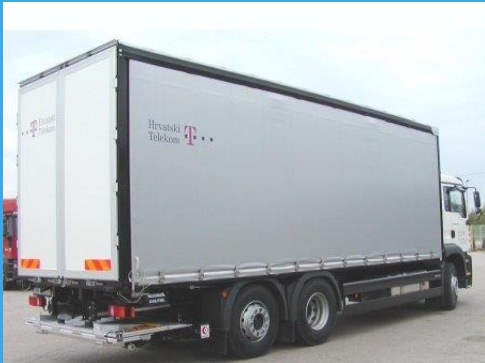
Slika 29. Primjer ugradnje utovarne platforme na veze osnovnog i dodatnog rama
