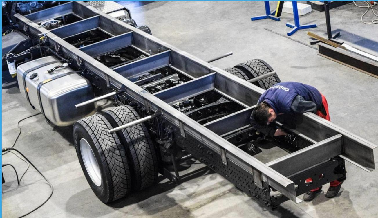
Slika 27. Primjer ugradnje veza osnovnog i dodatnog rama
