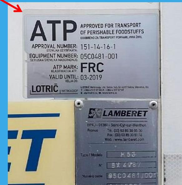
Slika 13. Označavanje ATP vozila
