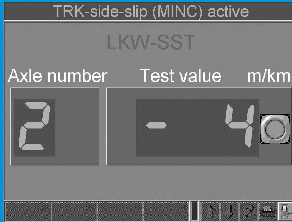
Mjerenje usmjerenosti točkova za drugu osovinu će biti urađeno, čim vozilom pređemo preko testne ploče (drugom osovinom/zadnjim lijevim točkom).
