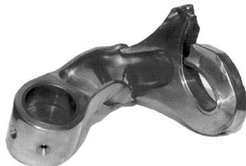
Primjer oštećenja klipnjače
