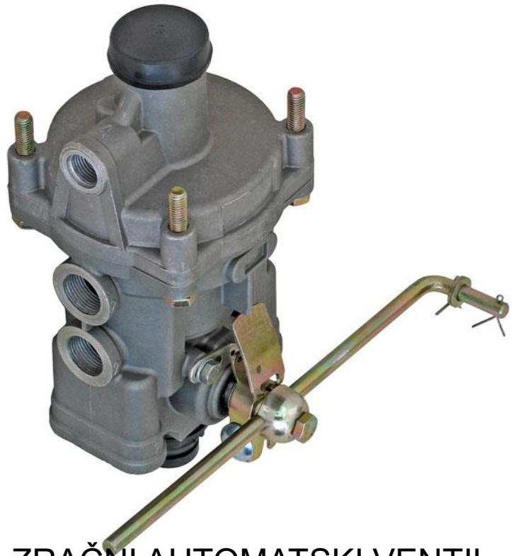
ZRAČNI AUTOMATSKI VENTIL
