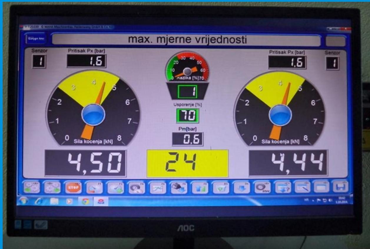
Slika. Prikaz prozora pri mjerenu maximalnih kočionih vrijednosti na osovini
