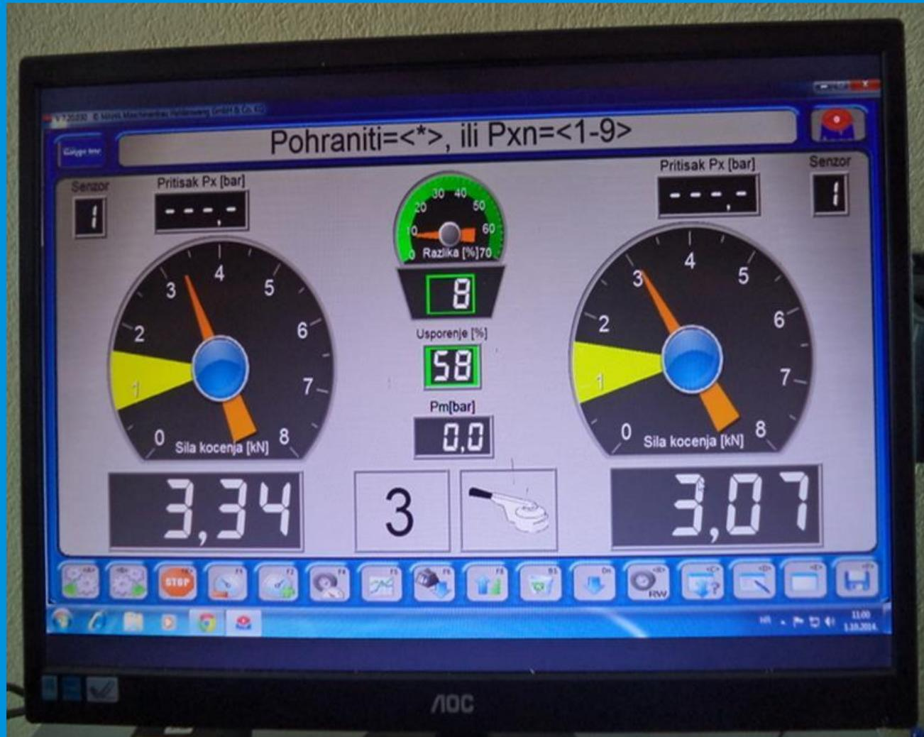
Slika . Prikaz ispitivanja pomoćne kočnice treće osovine
