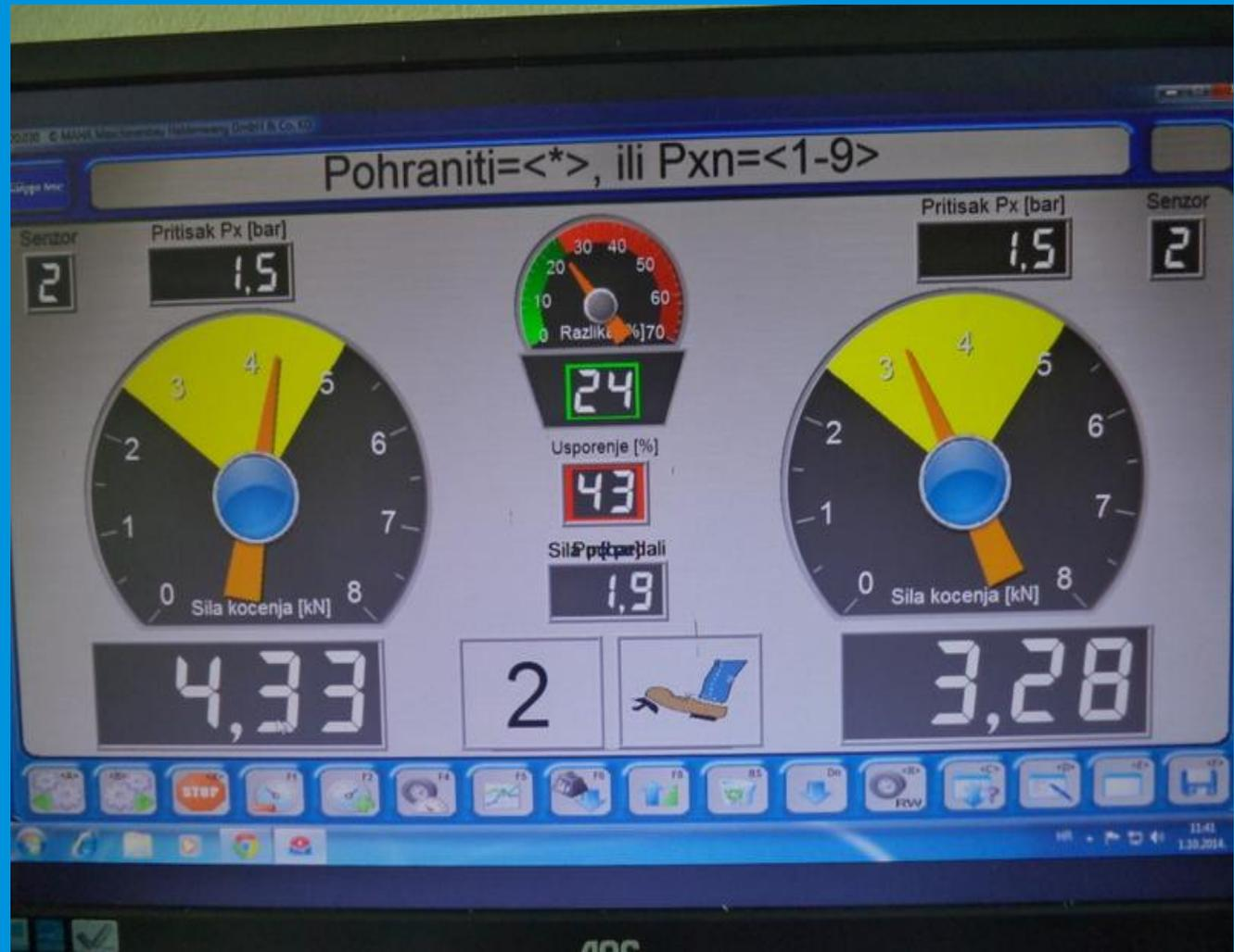
Slika . Prikaz ispitivanja radne kočnice druge osovine
