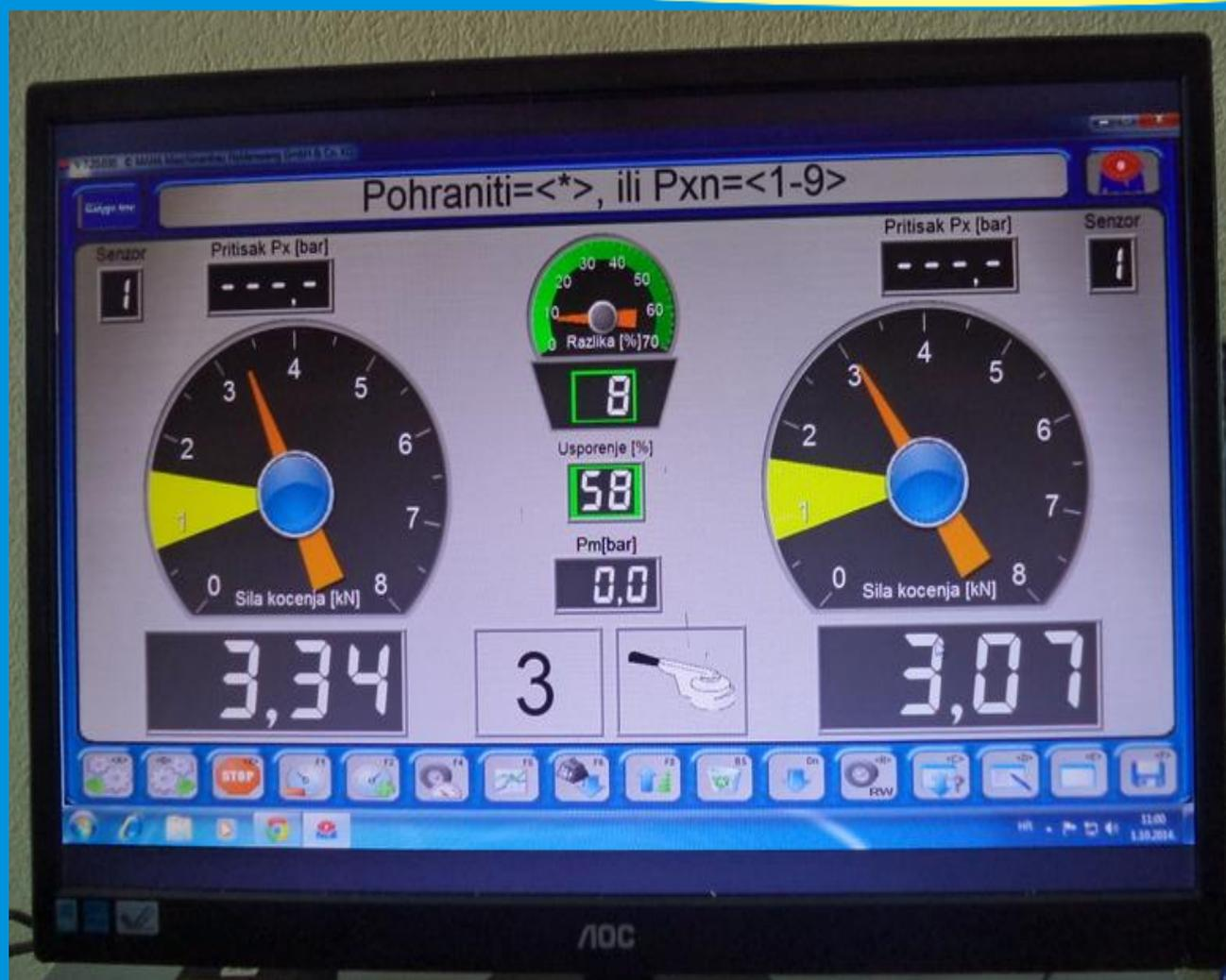
Slika . Prikaz ispitivanja pomoćne kočnice treće osovine
