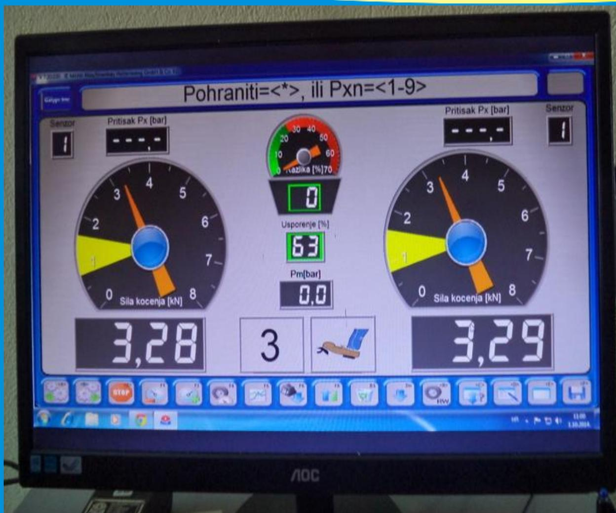
Slika . Prikaz ispitivanja radne kočnice treće osovine
