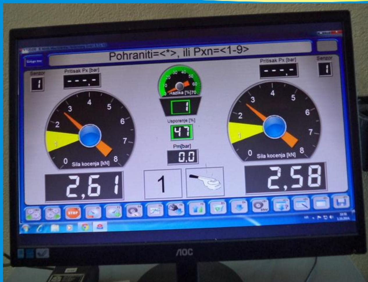
Slika . Prikaz ispitivanja pomoćne kočnice prve osovine
