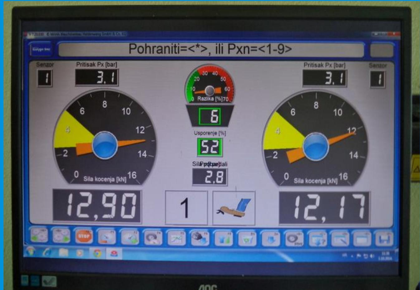
Slika . Prikaz ispitivanja radne kočnice prve osovine
