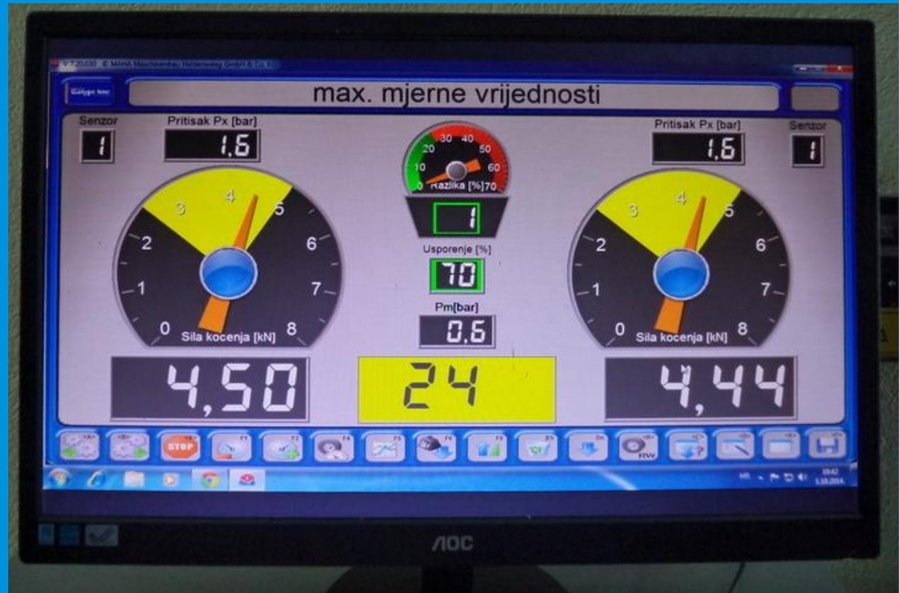
Slika. Prikaz prozora pri mjerenju maksimalnih kočionih vrijednosti na osovini
