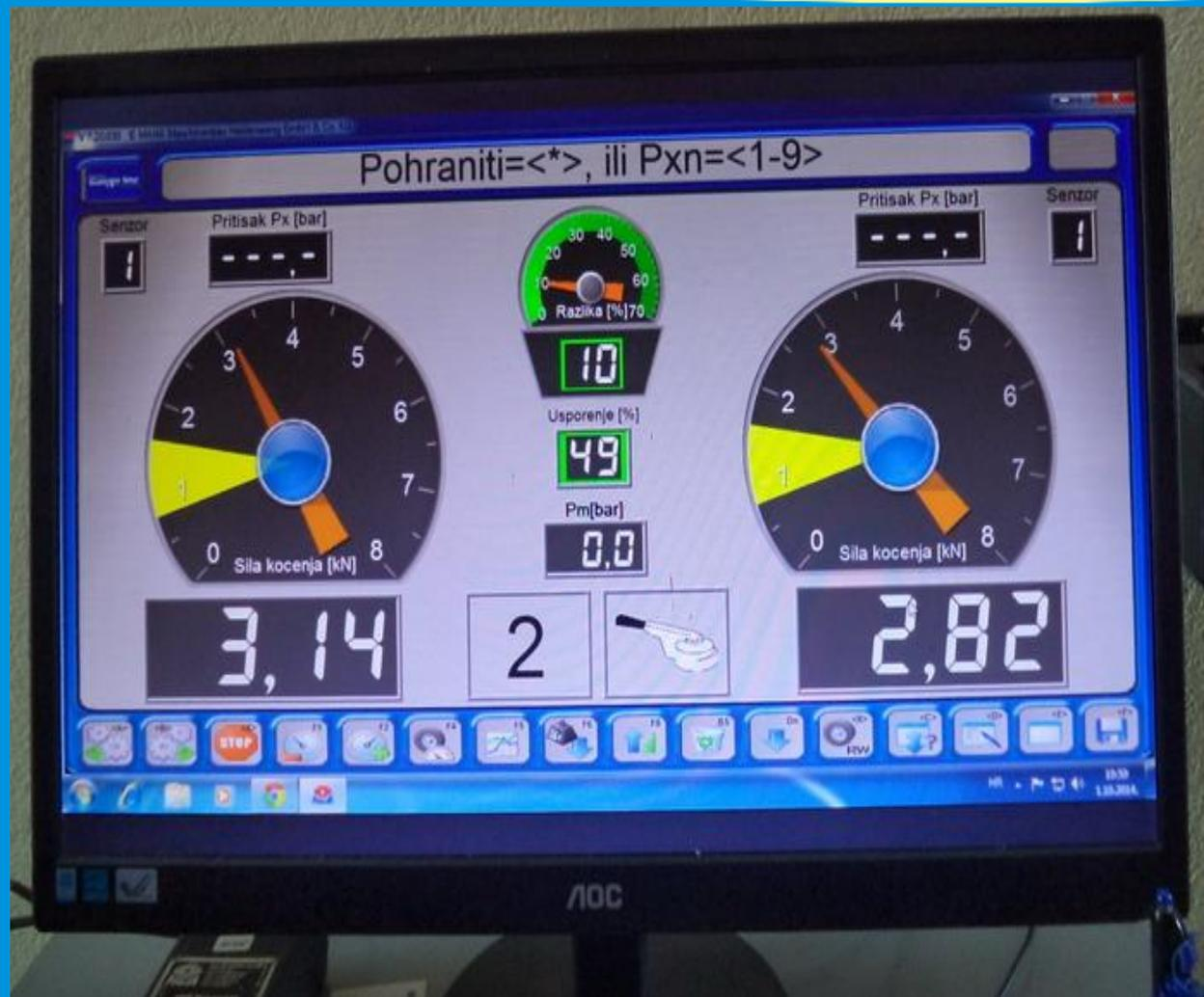
Slika . Prikaz ispitivanja pomoćne kočnice druge osovine
