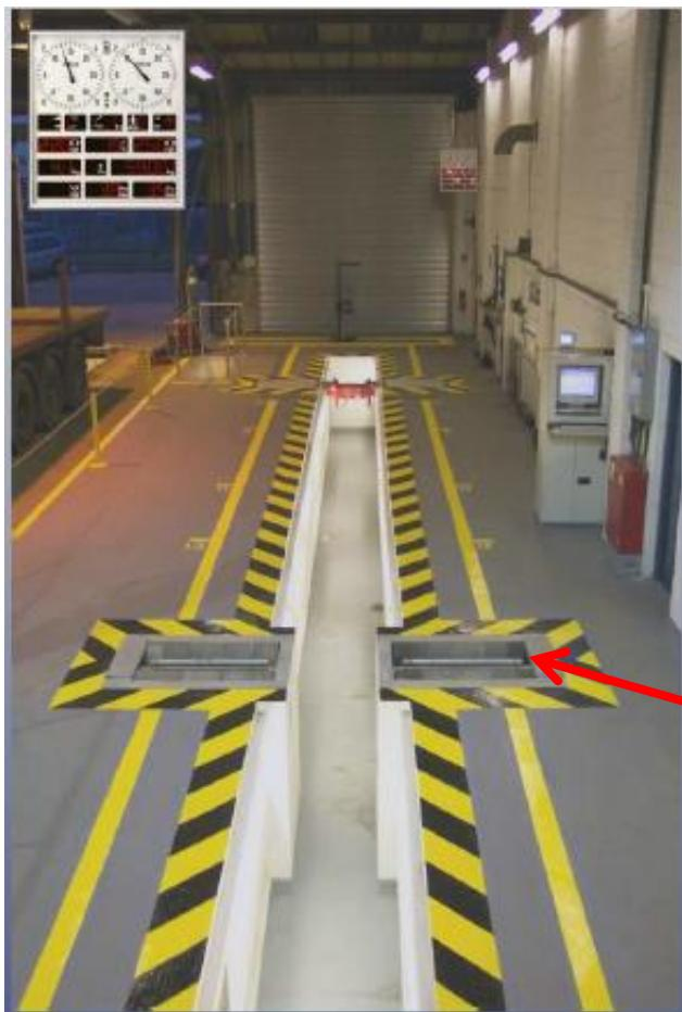
Ispitivanje kočnica se vrši najčešće na ispitnim linijama koje su opremljene između ostalog i ispitnim valjcima za mjerjenje sila kočenja.
