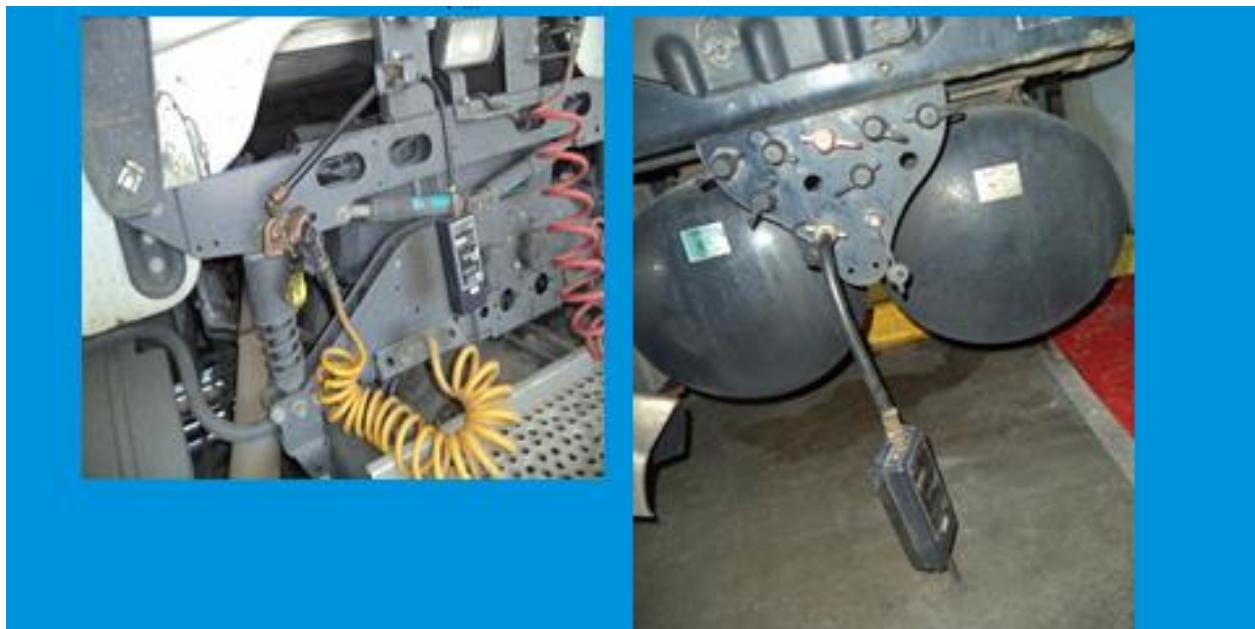
Slika 6. Postavka senzora  $P_m$  na vučnom vozilu
