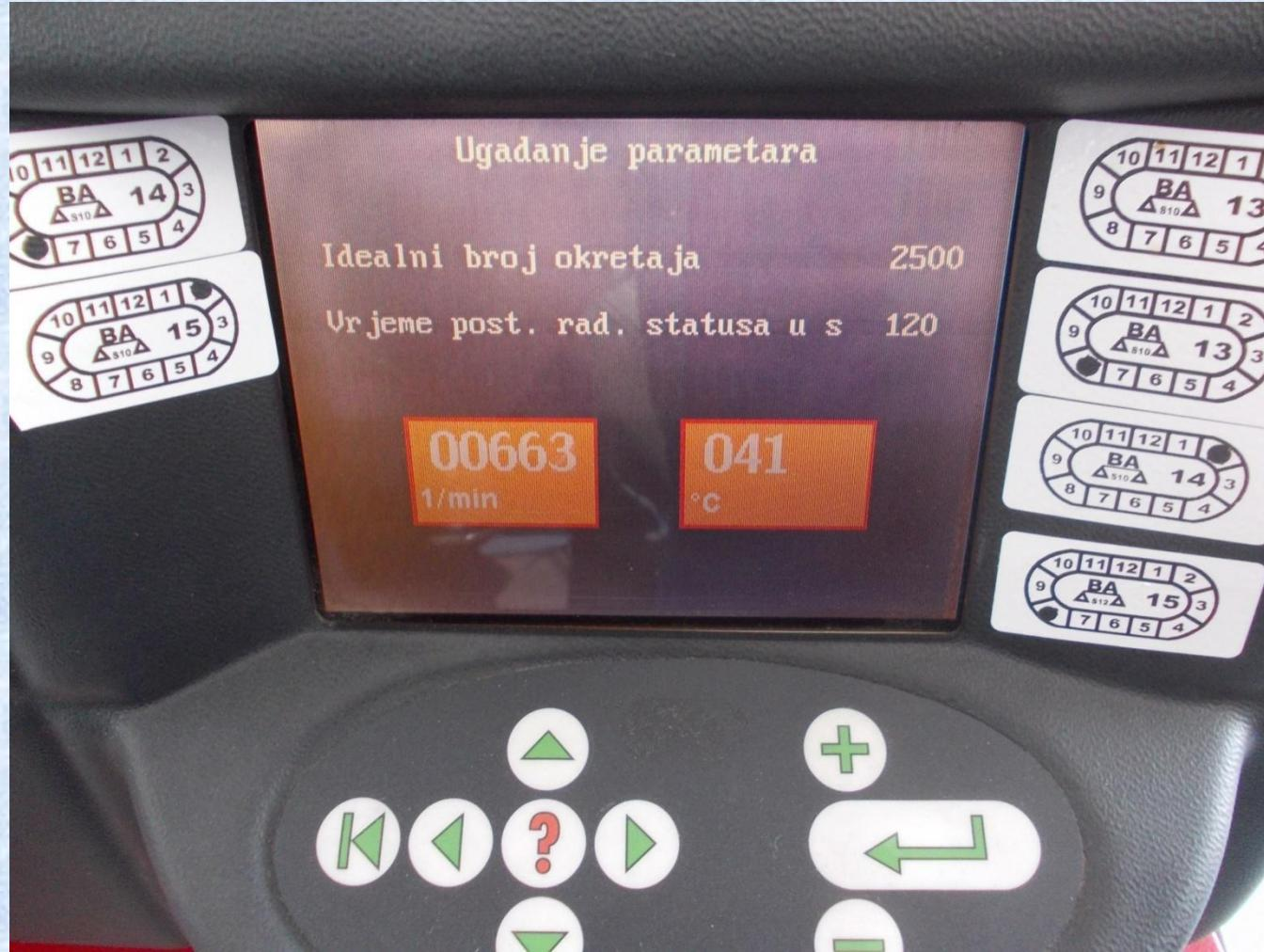
Ulje u motoru još nije zagrijano ( $41^{\circ}\text{C}$ ) što znači da se s kondicioniranjem katalizatora i mjerenjem još ne smije započeti.
