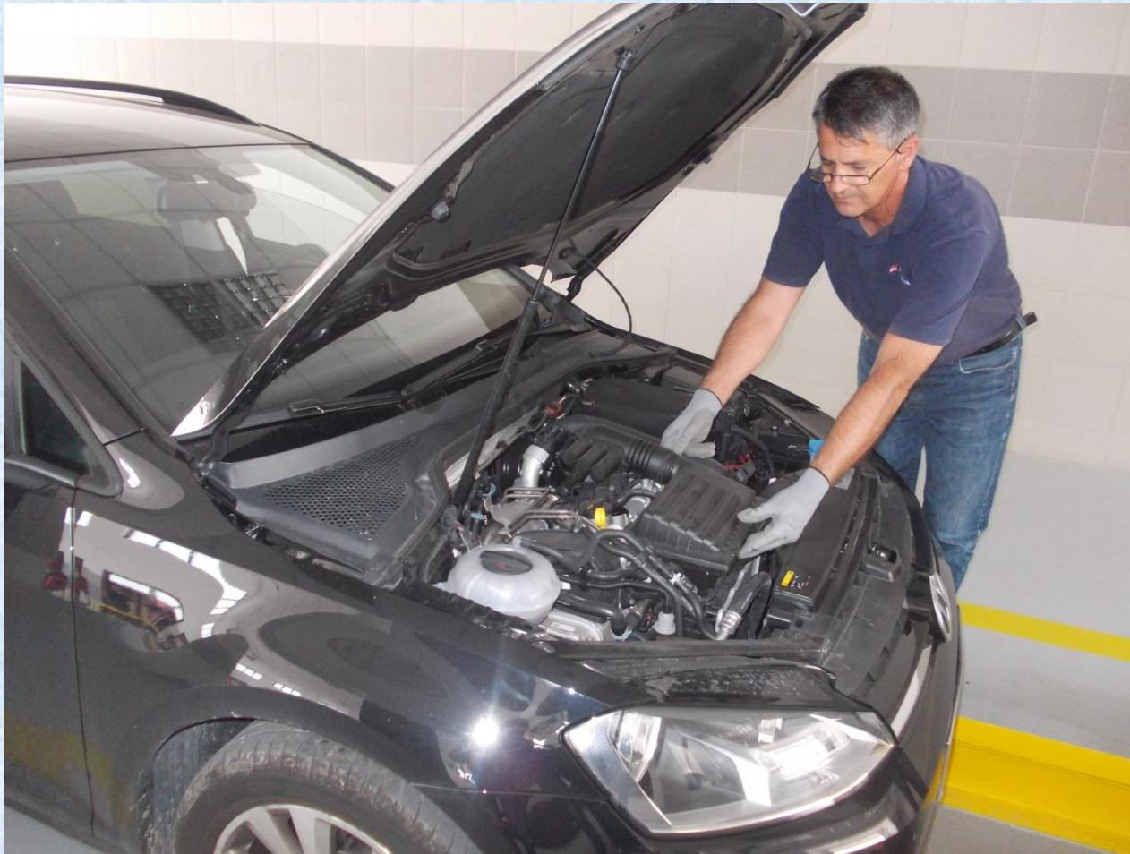
Pregled motornog prostora i učvršćenosti svih dijelova i sklopova u njemu.
