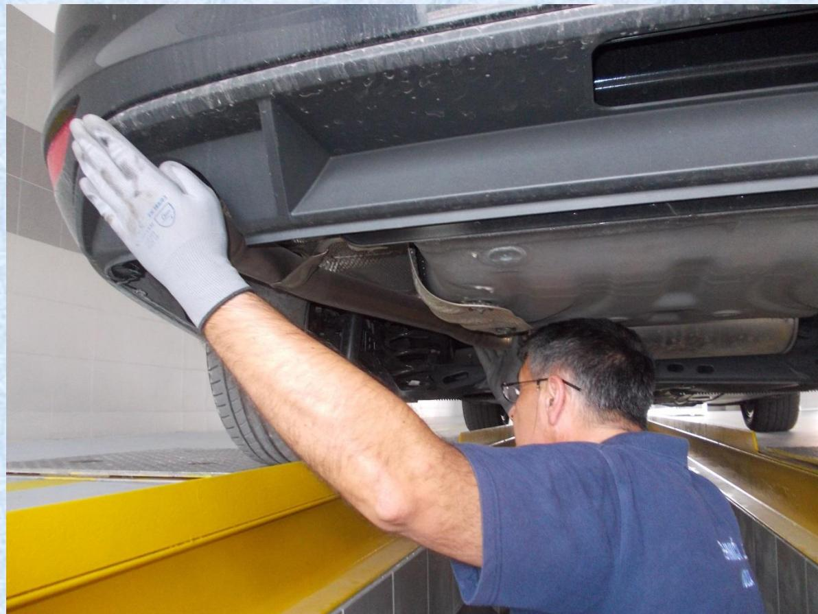
Zatvorite izlaz ispušne cijevi i osluškujte šištanje ispušnog plina - koristite neku staru, gustu krpnu.
