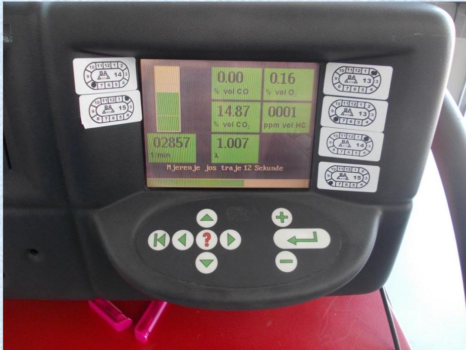
Motor i katalizator koji je u ovom primjeru ispitivan je bio u vrhunskoj kondiciji. Odmah na početku kondicioniranja katalizatora na povišenim okretajima (2857 o/min), mjerni rezultati su bili savršeni:
