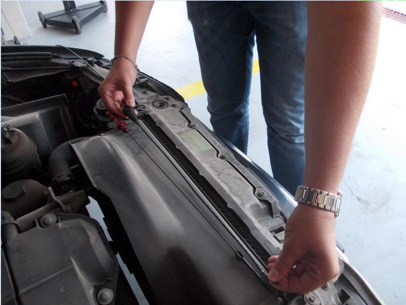
Prilagodite duljinu mjerne sonde za mjerjenje temperature šipki ulja. Ovako je to najbolje raditi – na gornjem veznom limu (ili deflektorskom limu hladnjaka), tj. na nekoj čvrstoj podlozi.
