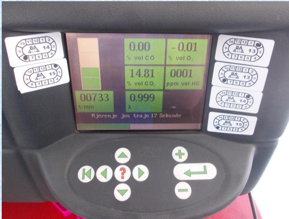
Nakon ispisanih (memoriranih) rezultata mjerena na povišenoj brzini vrtnje, kontrolor treba otpustiti papučicu za snagu tako da motor radi na brzini vrtnje praznog hoda.
