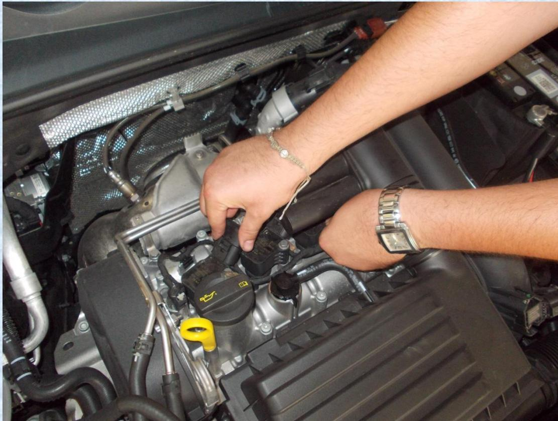
Kontrola vidljivog dijela električne instalacije paljenja smjese.
