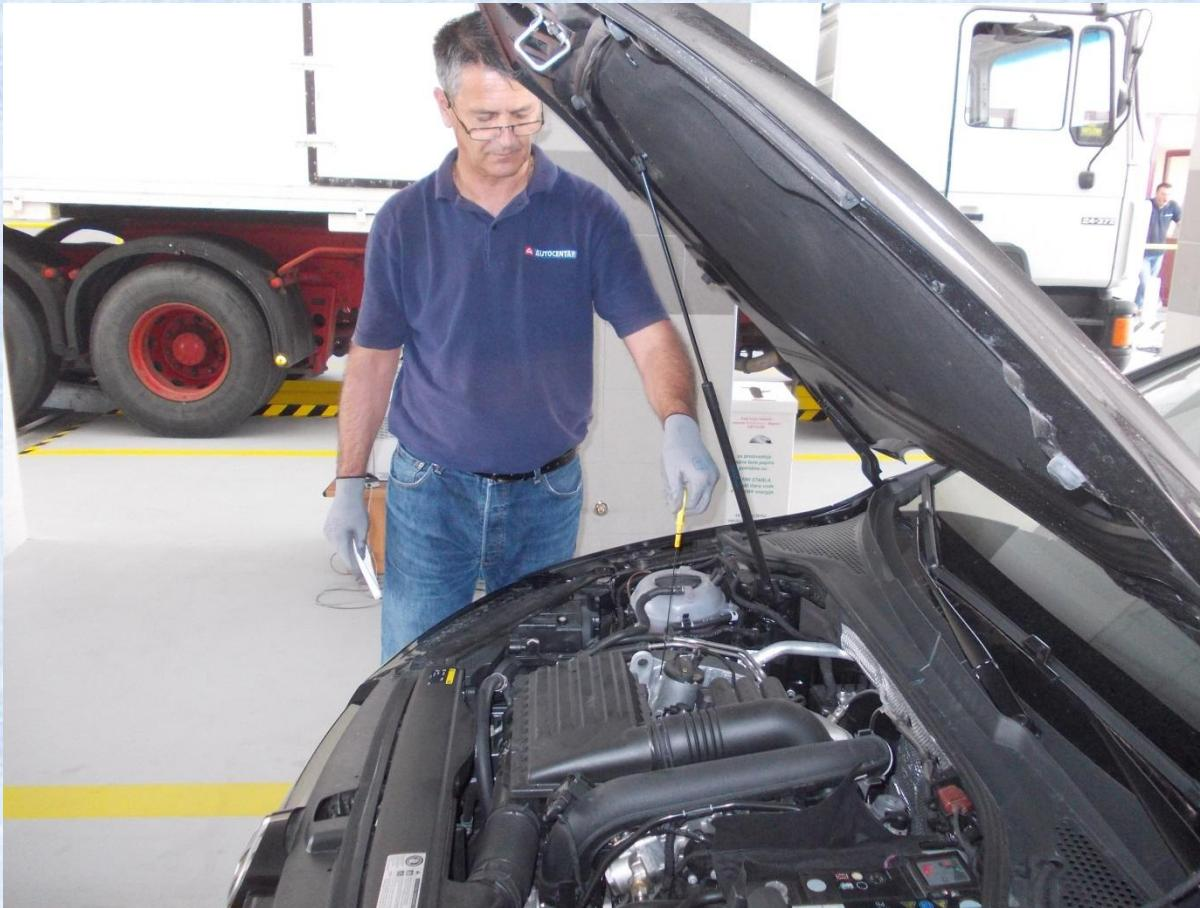
Kontrola količine ulja u motoru (Pozor – neki najnoviji motori nemaju mehaničku šipku za mjerjenje količine ulja u motoru).
