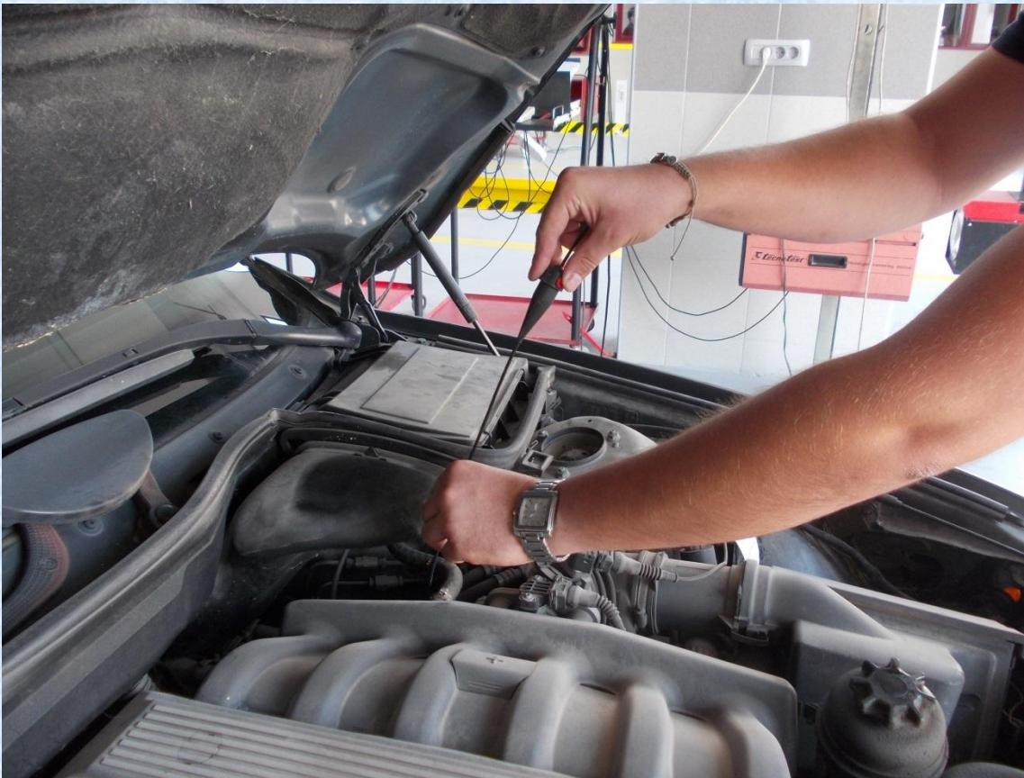
Nakon ispisa rezultata mjerenja, motor treba ugasiti te s vozila skinuti sve mjerne priključke (indukcijska klješta, mjerač temperature ulja i sondu iz ispušne cijevi) te na svoje mjesto vratiti šipku ulja.
