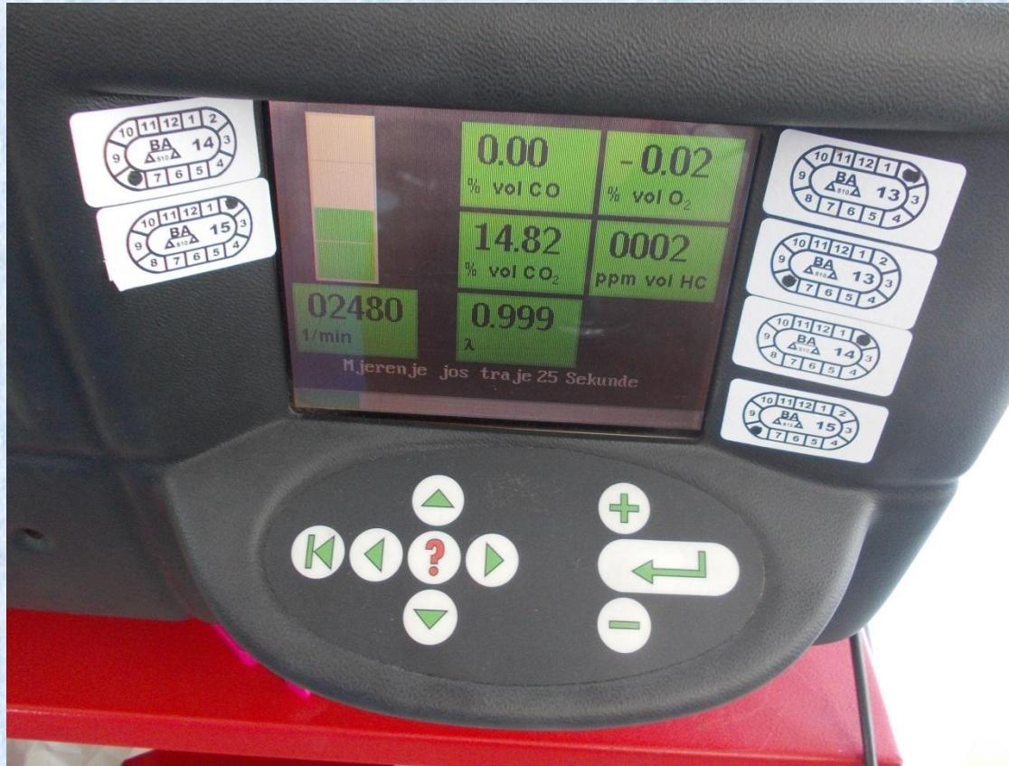
Nakon što se odrade uvjeti potrebni za kondicioniranje katalizatora, kako je sonda već postavljena u ispušnu cijev, obavlja se samo prilagodba brzine vrtnje na zahtijevanu brzinu vrtnje te ispitivanje ispušnih plinova pri povišenoj brzini vrtnje.
