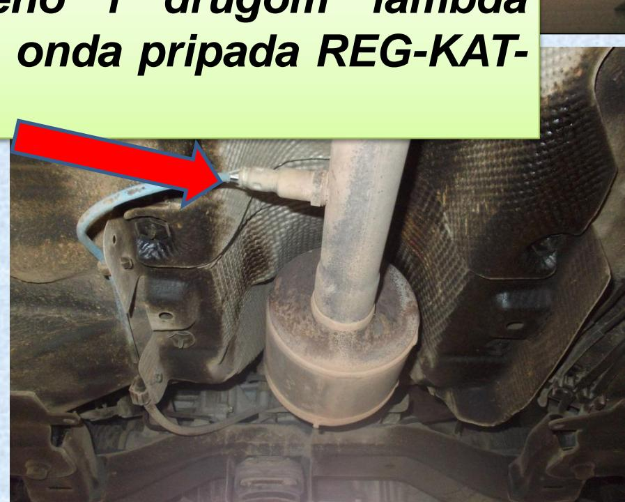
Već smo mnogo puta rekli – prvo pokušajte pronaći lambda sondu. Postojanje lambda sonde osnovni je pokazatelj da vozilo pripada skupini REG-KAT ili REG-KAT-OBD kategoriji vozila. Ako je vozilo proizvedeno 2003. godine i nakon te godine, onda pripada kategoriji REG-KAT-OBD motora.
