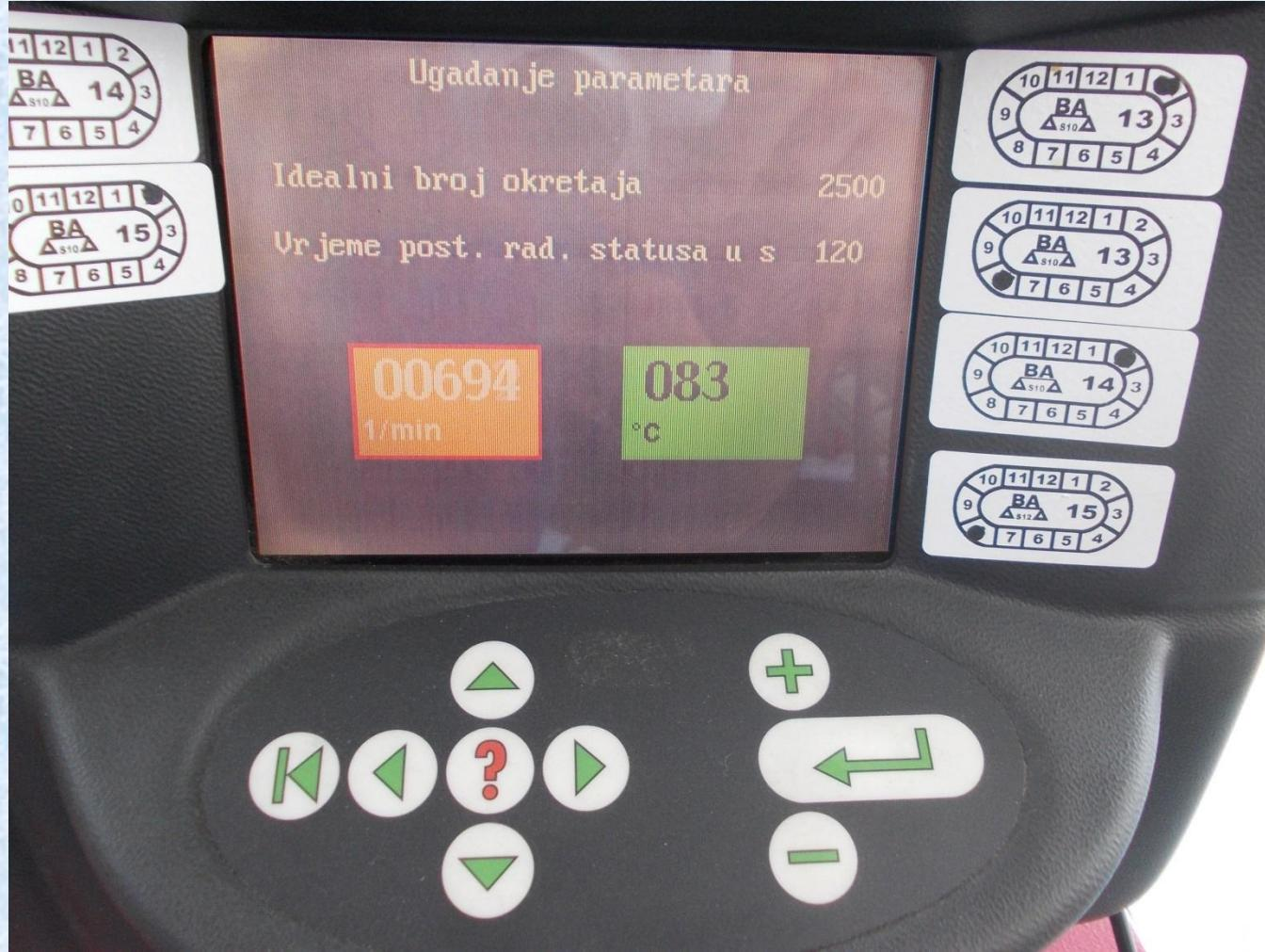
Motor je zagrijan ( $83^{\circ}\text{C}$ ). Tek sada slijedi kondicioniranje katalizatora i mjerjenje ispušnih plinova.
