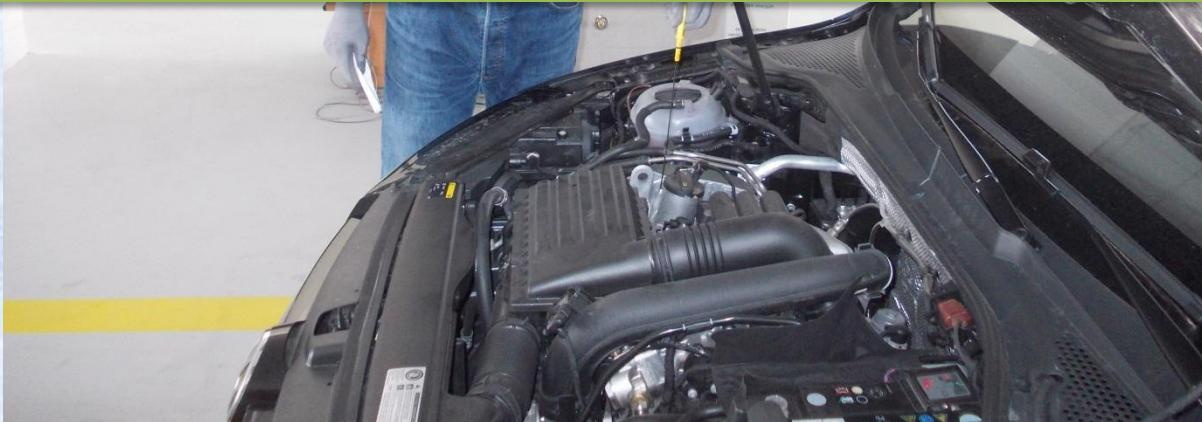
Kontrola količine ulja u motoru (Pozor – neki najnoviji motori nemaju mehaničku šipku za mjerjenje količine ulja u motoru).
