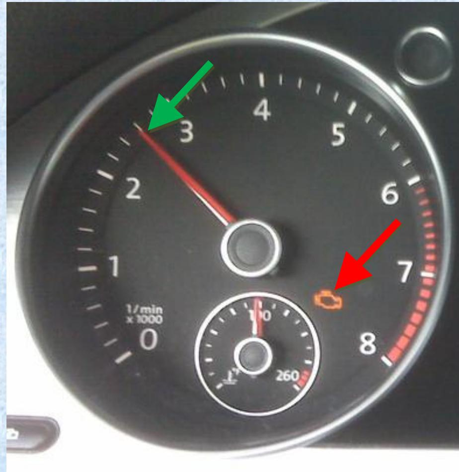
Također je na ploči s instrumentima potrebno provjeriti da li se nakon pokretanja motora gasi kontrolna lampica paljenja i ubrizgavanja goriva (check engine).
