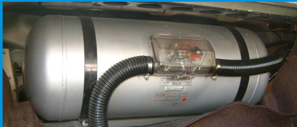
*LPG cilindrični rezervoar*
