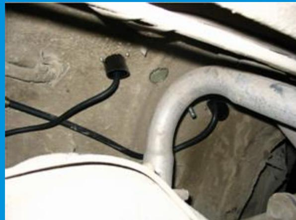
Nedozvoljen položaj cijevi visokog pritiska izduvnoj cijevi
