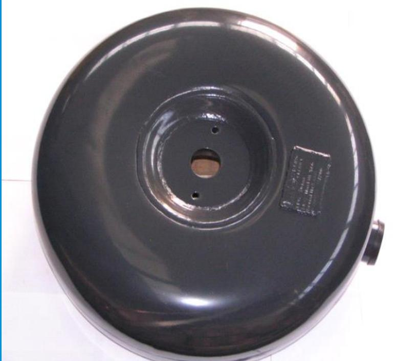
*LPG toroidalni rezervoar*
