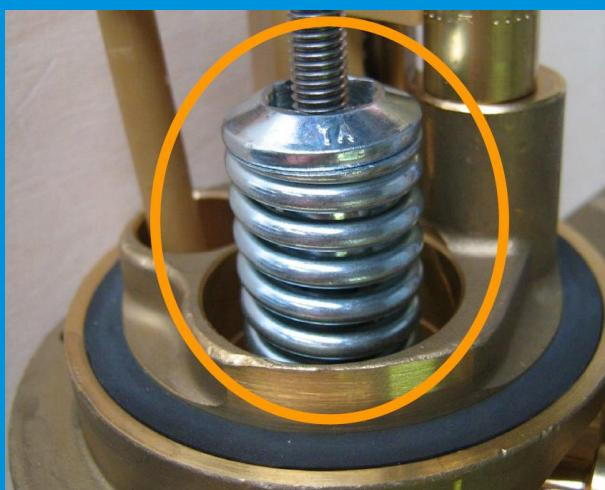
Ispusni ventil, koji se aktivira pri 27 bar u rezervoaru. Sprečava eksploziju rezervoara.
