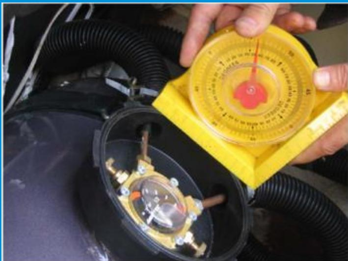
Kontrola ugradnje (položaja) multiventila na rezervoaru
