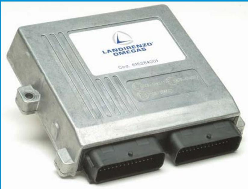
*Mikroprocesor 16 bit 50MHz*
