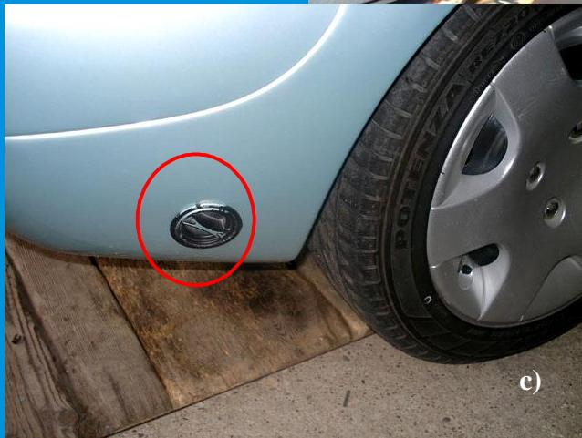
a) položaj rezervoara, b) prekidač za pogon vozila na gas, odnosno benzin, c) priključak za punjenje gasom
