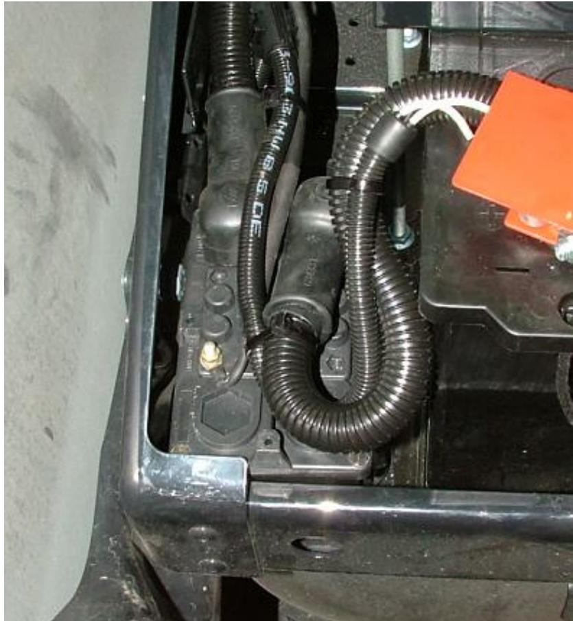
Gl. prekidač ima zaštitu spojeva: ***IP54*** ***S GUMENIM KAPAMA*** ***BEZ ZAŠTITE***
