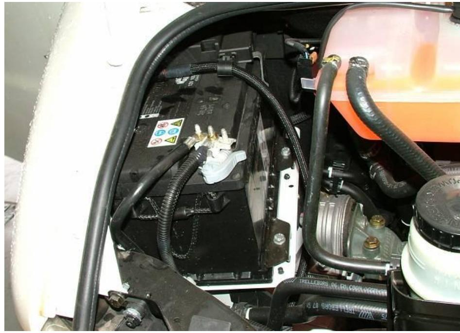
Akumulatori su u ventiliranoj kutiji ili pod poklopcem motora: **DA**
