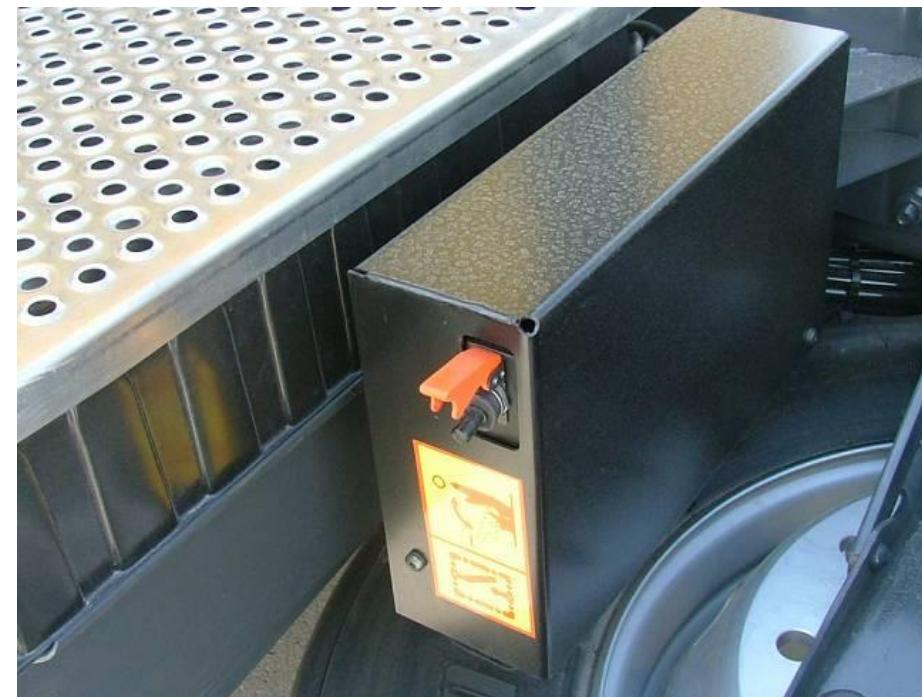
Gl. prekidač ima zaštitu spojeva: **IP54** **S GUMENIM KAPAMA**
