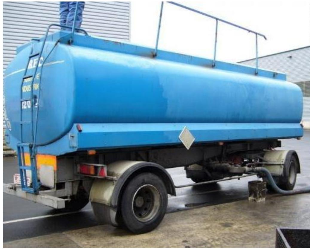
Mehanička zaštita opreme na vrhu spremnika: **DA** **NE**
