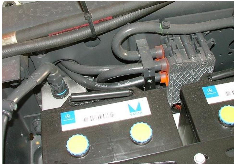
Glavni prekidač akumulatora je u IP65 kućištu: **DA**
