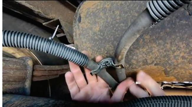
**Slika 3.** Provjera stanja zaštitne obloge na kočionim zračnim vodovima
