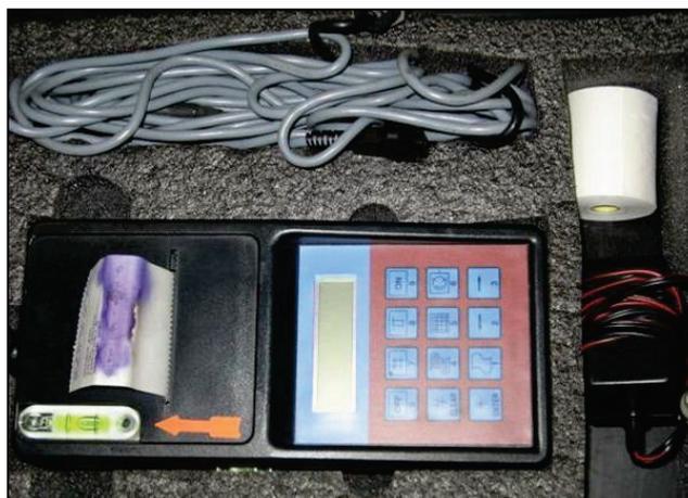
Slika 2. Uređaj za mjerenje usporenja vozila MAHA VZM 100
