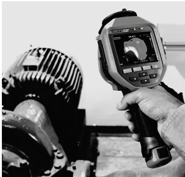
**Slika 2.7.** Mjerjenje temperature termovizijskom kamerom
