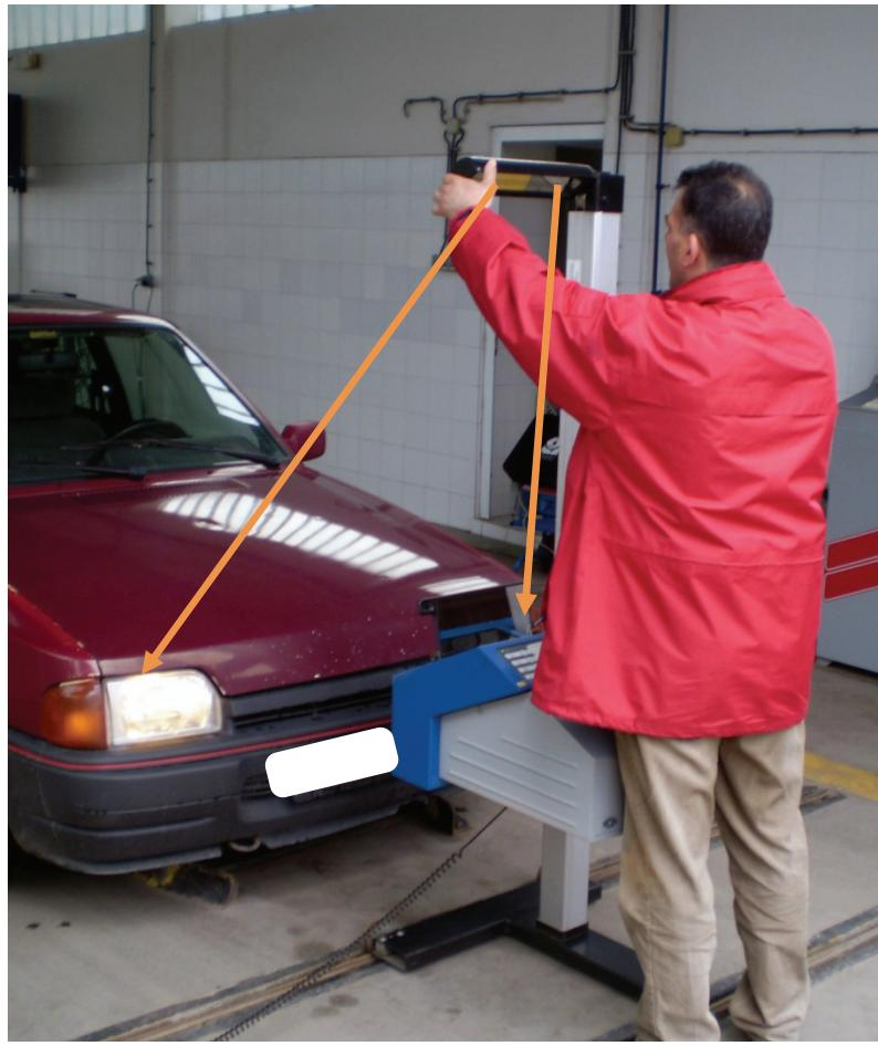
**Slika 9.** Podešavanje regloskopa od strane kontrolora tehničke ispravnosti vozila
