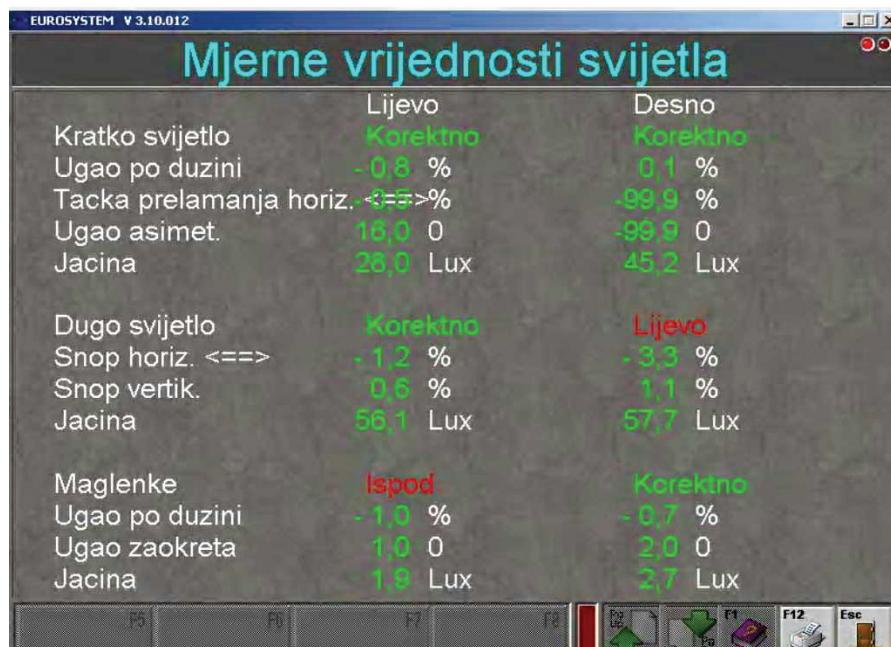
Slika 21. Konkretan primjer izmjerena rezultata na reflektorima na vozilu
