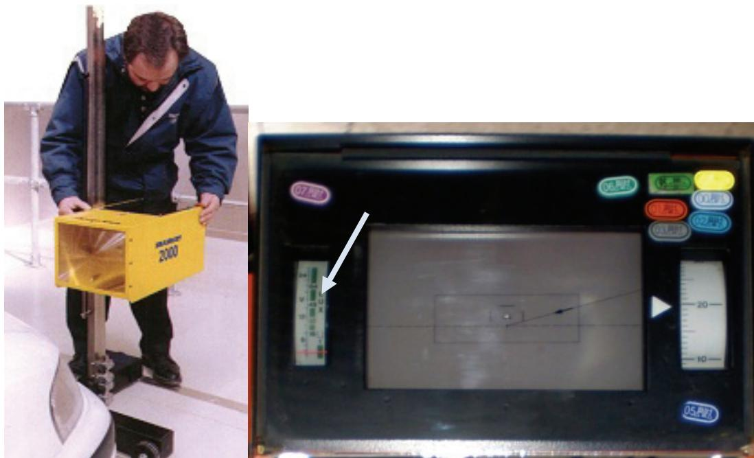
**Slika 12.** Primjena regloskopa za mjerjenje jačine svjetlosti
