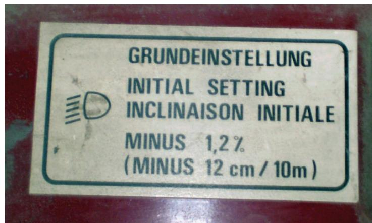
**Slika 3.** Znak pada snopa svjetlosti za kratka svjetla – vozilo marke FORD, model ESCORT
