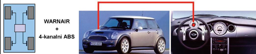
Slika 24. Primjer ugradnje sistema za nadzor pritiska u gumama
