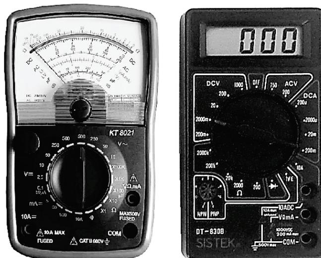
**Slika 3.8.** Analogni i digitalni multimeter
