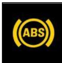
Glavna uloga sistema za sprečavanje blokiranja točkova pri kočenju ABS (anti-lock braking system) je veća sigurnost, kraći zaustavni put vozila, bolja upravljaljivost vozila, veći komfor prilikom kočenja. ABS je dograđeni elektronski sistem na standardni kočioni sistem vozila i s njim je kompatibilan. To znači, da u slučaju kvara na ABS-u, standardni kočioni sistem i dalje normalno funkcioniše.
