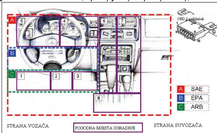
**Slika 4. Moguća mjesta ugradnje konektora na vozilu**
