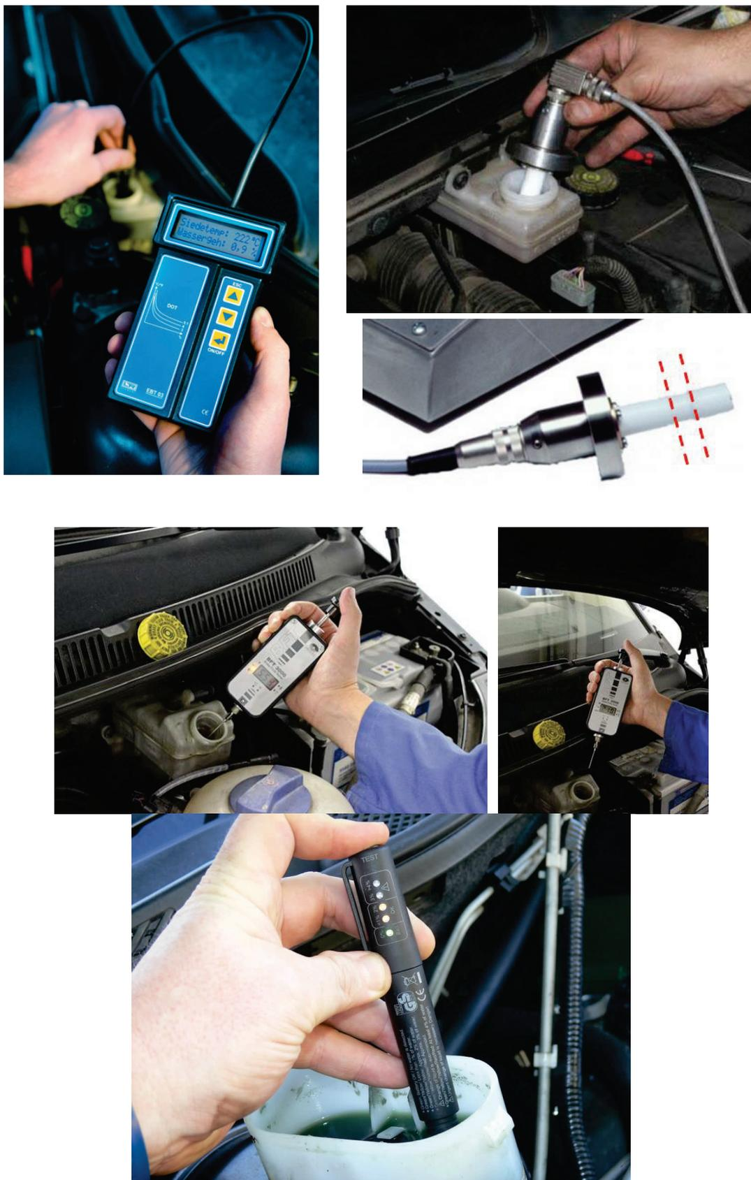
**Slika 5.** *Primjeri upotrebe različitih uređaja za kontrolu tačke ključanja kočione tečnosti*
