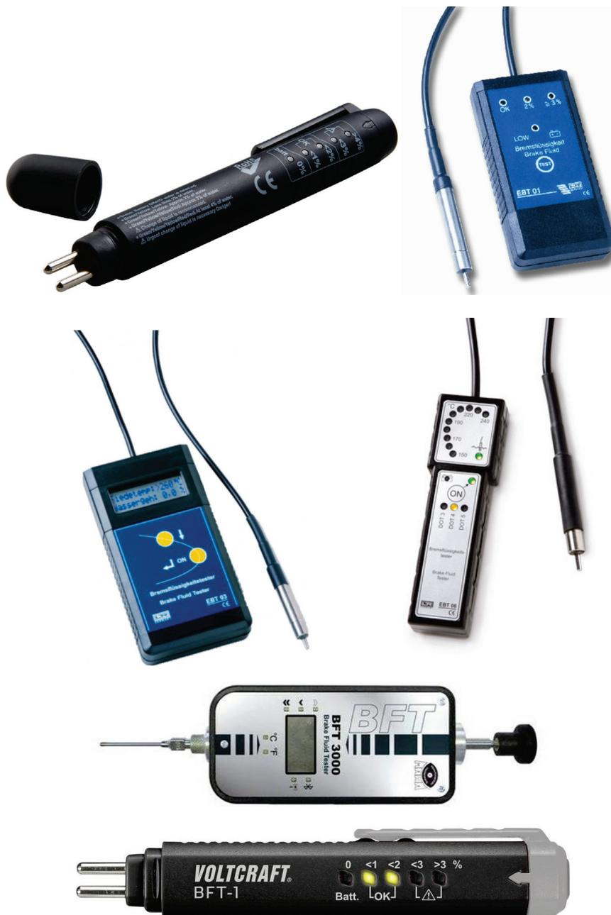
*Slika 4. Različiti primjeri uređaja za kontrolu tačke ključanja kočione tečnosti*
