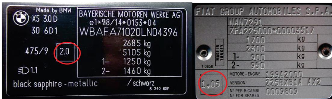
Slika 2. Podaci o zacrnjenosti izduvnih gasova dizel motora
