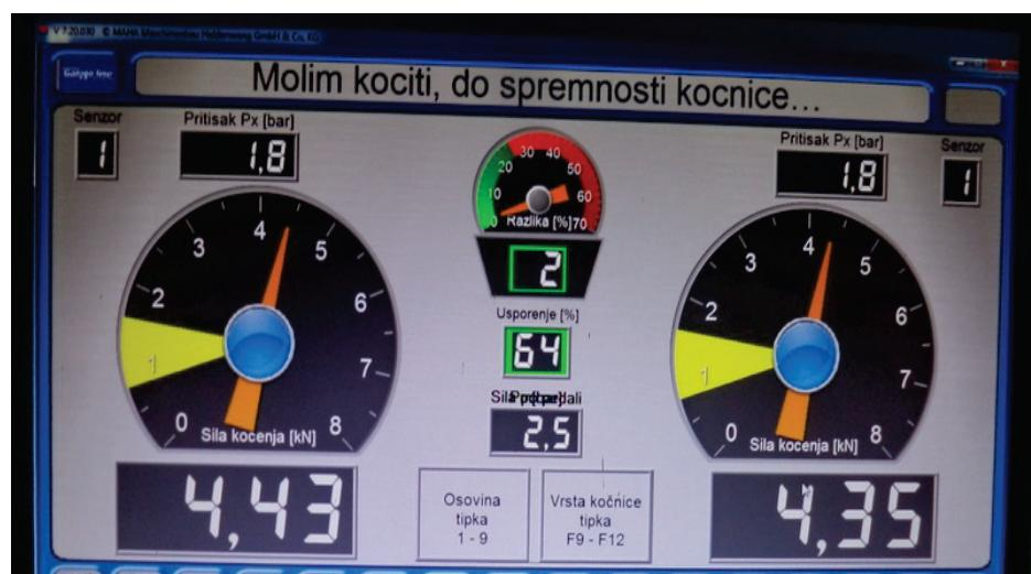
*Slika 15. Prikaz prozora za mjerene kočenja na radnoj kočnici osovine*
