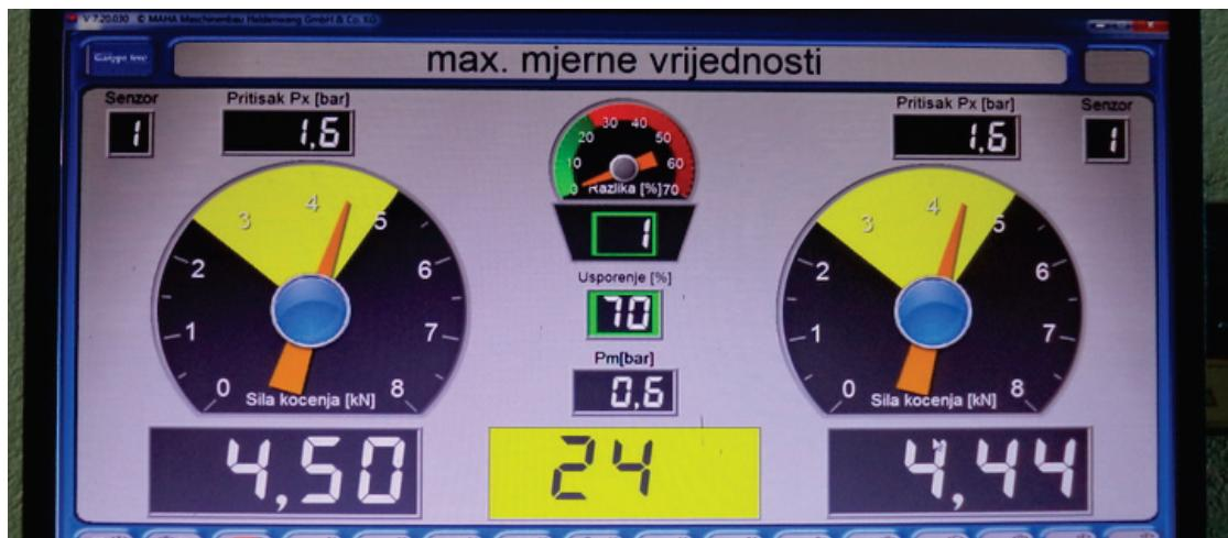
**Slika 16.** Prikaz prozora pri mjerenu maximalnih kočionih vrijednosti na osovini
