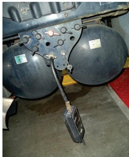
**Slika 6. Postavka senzora  $p_m$  na vozilu**
