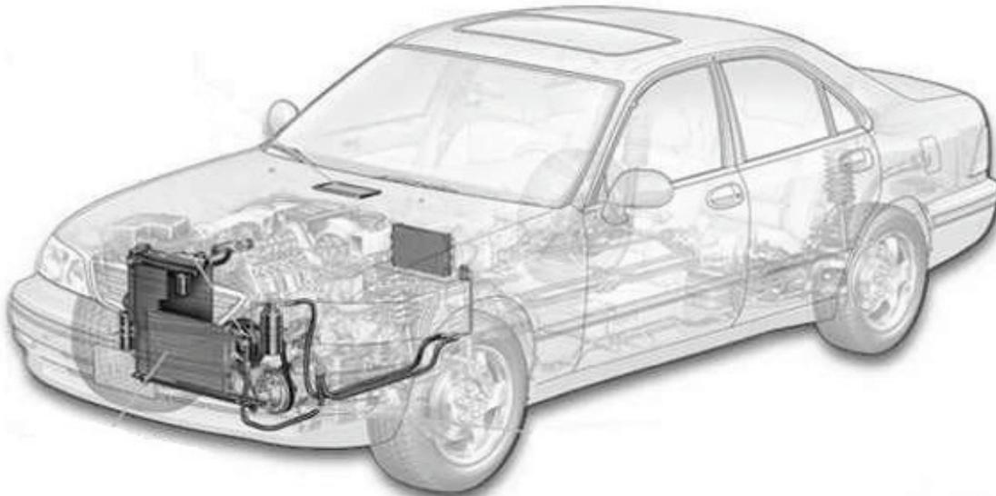
**Slika 1.** Sistem za hlađenje motora automobila
