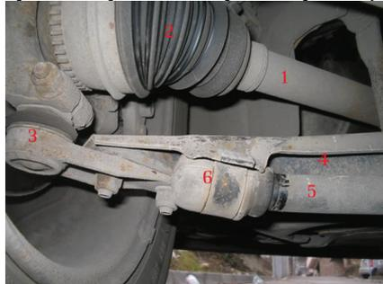
(1-poluosovina, 2-homokinetički zglob-gumena manžetna, 3-krajnica-kuglasti zglob, 4-donje oscilirajuće rame-lafet, 5-stabilizator, 6-uležištenje stabilizatora )
