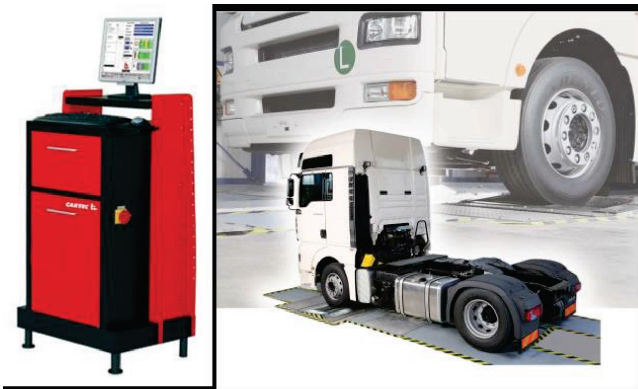
**Slika 2.** BDE 4504 G SC - 16 t – Tester kočenja s valjcima za aute i kamione do 16 t osovinskog opterećenja
