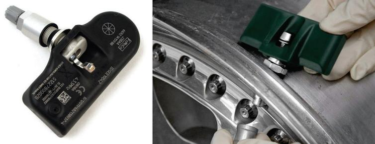
Slika 2. Senzori direktnog sistema kontrole
