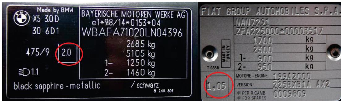
Slika 12. Podaci o zacrnjenosti izduvnih gasova dizel motora
