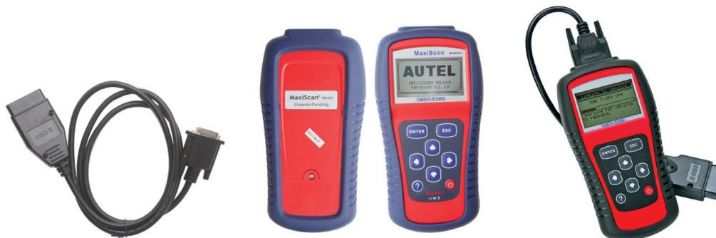
Slika 13. OBD čitači sa pripadajućom opremom – primjeri
