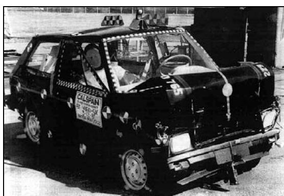
Slika 7. Izgled oštećenja dva susedna dela vozila (dijagonalni snimak)
