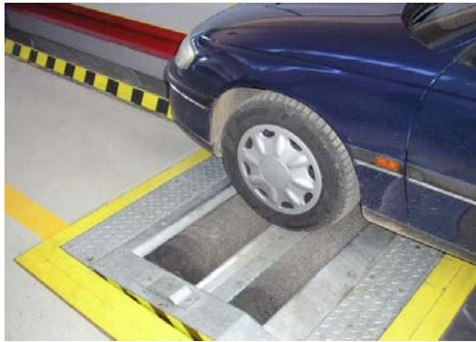
**Slika 13. Testiranje kočnica u valjcima.**
