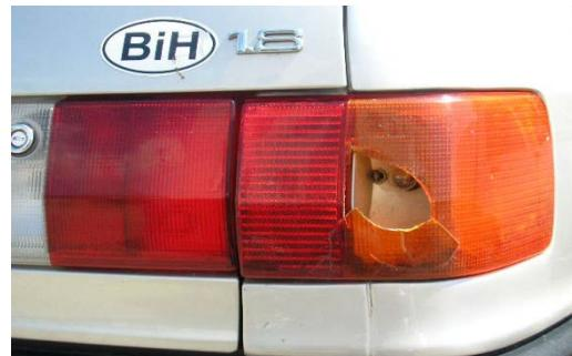
**Slika 18.** Oštećeni uređaji za signalizaciju
