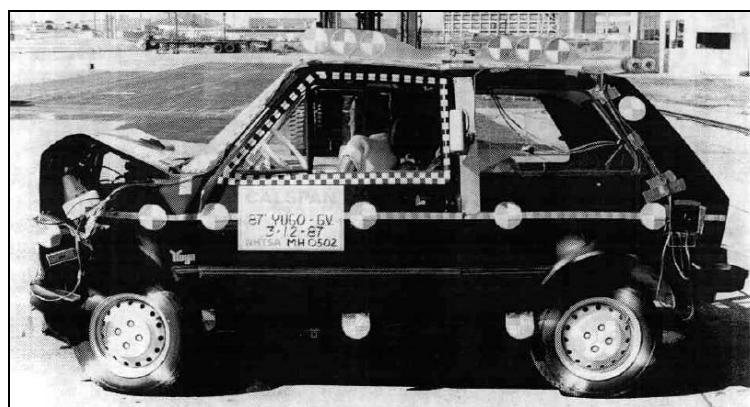
Slika 6. Izgled oštećenja levog bočnog dela vozila
