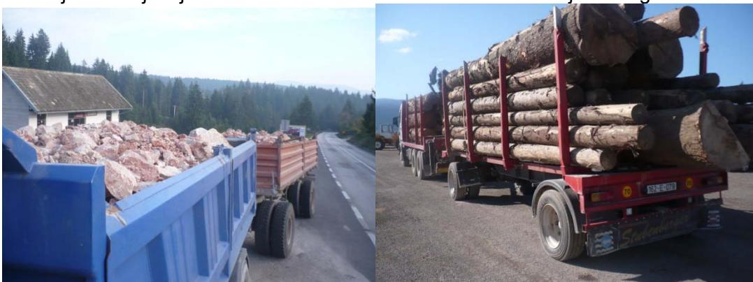
Fotografija 1 a i 1b Primjer vozila koje je zabilježila Federalna inspekcija na terenu a koji su opterećeni preko dopuštene nosivosti<sup>12</sup>
