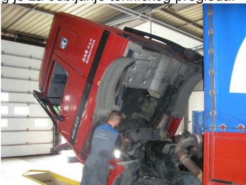
**Slika 36.** Podignuta kabina motornog vozila spremna za pregled motora.
