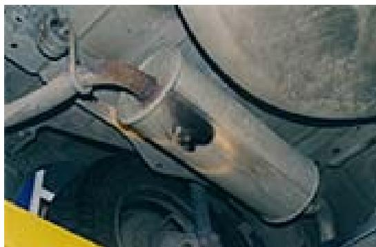
*Slika 25. Progoreni stražnji tonac izduvnog sistema – ovakav kvar se čuje a ne samo vidi*
