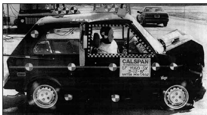
Slika 8. Izgled oštećenja desnog bočnog dela vozila
