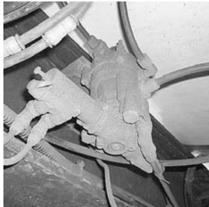
**Slika 33.:** Pneumatski upravljan ARSK ventil
