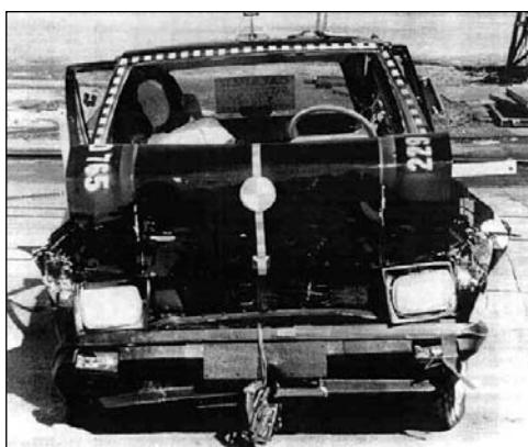
Slika 5. Izgled oštećenja prednjeg dela vozila
