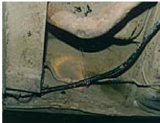
**Slika 35.** Kontrola sajle ručne kočnice
