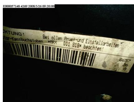
Slika 6.: Bar kod broja motora na zupčastom remenu[4]
