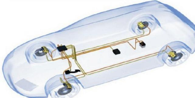
Slika 13. Raspored komponenti EWB sistema u vozilu i izgled protutipa sa jednim elektromotorom.
