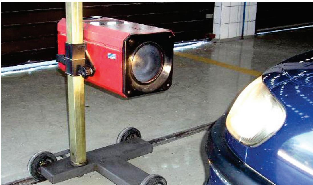
Slika 3. Uređaji za kontrolu svjetlosnih uređaja (regloskop)
