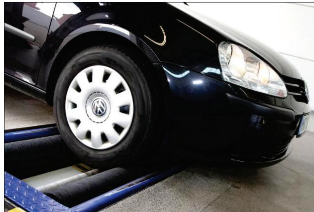
**Slika 1.** Ispitivanje kočionog sistema na valjcima za ispitivanje kočnica vozila
