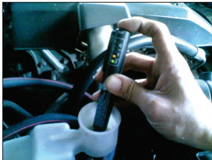
Slika 10. Indikator za mjerjenje isparavanja kočione tečnosti kočionog sistema
