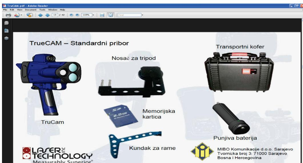
Uređaj ima u sebi integriran laser sa digitalnom kamerom, što LTI20-TruCAM čini naj sofisticiranim alatom za mjerjenje brzine koji je trenutno dostupan na tržištu. Uređaj prikuplja kompletan lanac dokaza u formi video zapisa visoke rezolucije, pomoću kojega je moguće identificirati vozilo sa naznakom o proizvođaču vozila, modelu, registarskom oznakom i vizuelnim karakteristikama osobe koja je upravljala vozilom.
