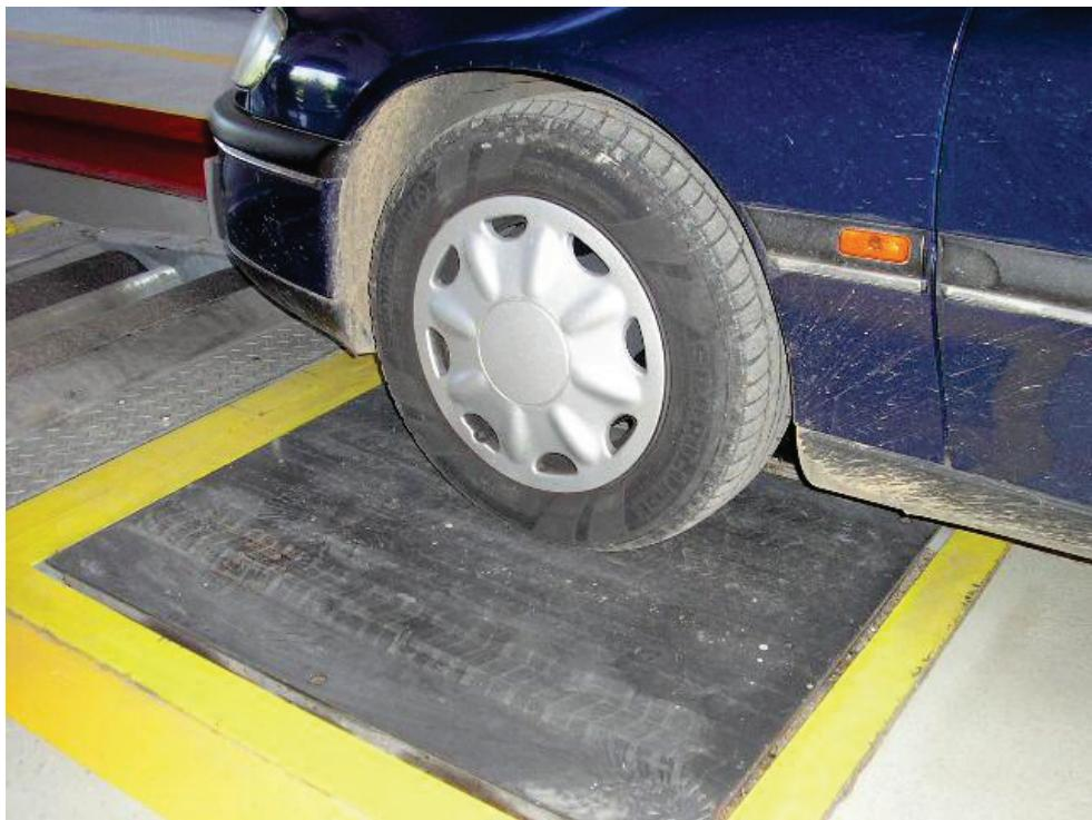
Slika 9. Nagazna ploča za kontrolu usmjerenosti točkova
