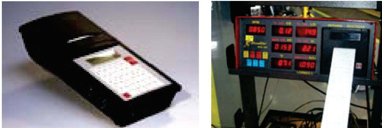
Slika 4. Primjeri uređaja za kontrolu emisije izduvnih gasova vozila
