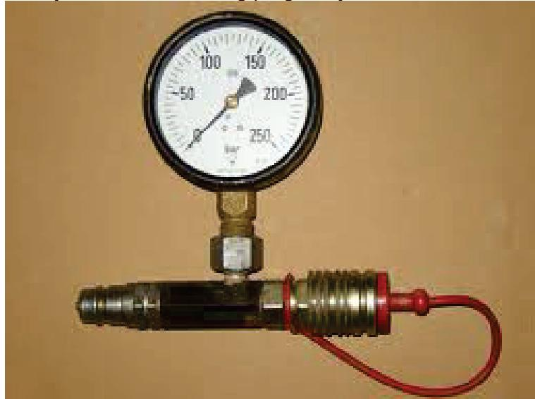
Slika 7. Izgled manometra za mjerjenje pritiska u pneumaticima vozila
