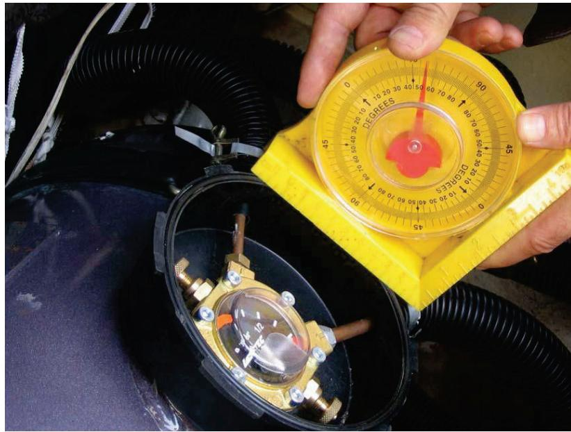
Slika 2. Ugao ugradnje multiventila nije  $30^\circ$
