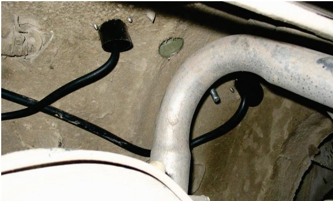
Slika 5. Nedozvoljeno rastojanje cijevi visokog pritiska od izduvne cijevi
