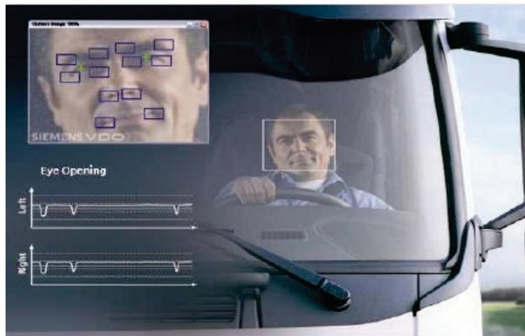
Slika 10. Sistem za praćenje opreznosti vozača
