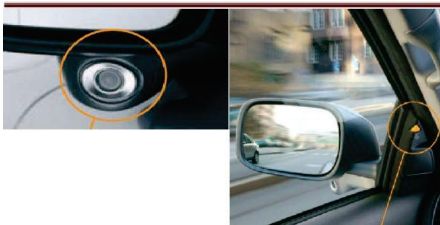
Slika 8. Smještaj digitalne kamere i signalnog svjetla
