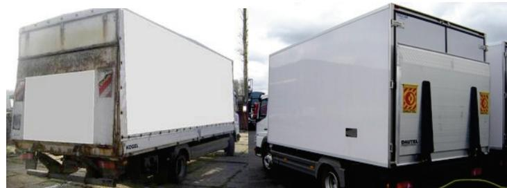
**Slika 3.** Promjena tovarnog sanduka - iz otvorenog u otvorenou sa utovarnom platformom
