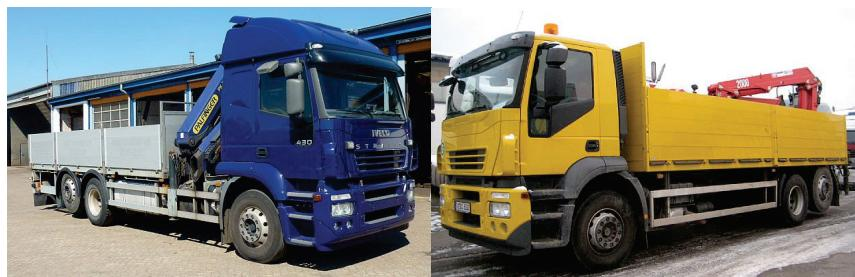
**Slika 2.** Promjena tovarnog sanduka - iz otvorenog u otvorenou sa utovarnom dizalicom i obratno
