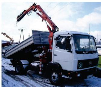
**Slika 6.** Promjena tovarnog sanduka - iz otvorenog u kiper vozilo sa utovarnom dizalicom i obratno
