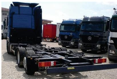
**Slika 8.** Promjena tovarnog sanduka - iz otvorenog /zatvorenog ili vozilo bez nadogradnje u vozilo promjenljive nadogradnje i obratno
