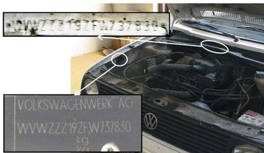
Slika 3 – VIN oznaka kod vozila marke VOLKSWAGEN (VW) tip 19E (Golf 2) (pozicije 2 i 7, slika 1)
